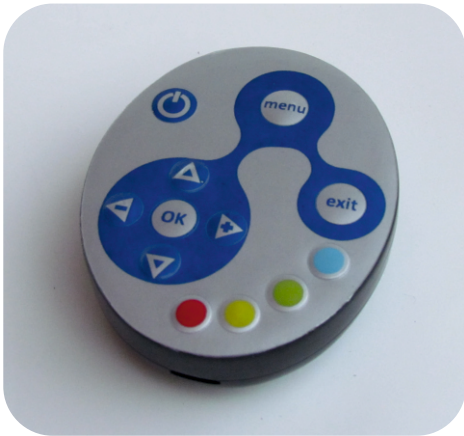
Botonera realizada en PVC serigrafeado (Serigrafía realizada por Eduardo CDI)
