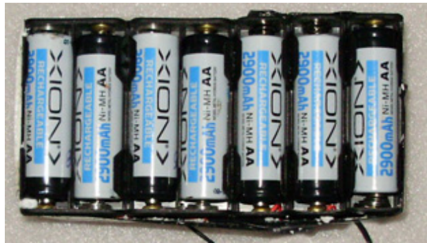
Figura 7.3.1: Pack de 14 baterías Ni-Cd marca Xion
