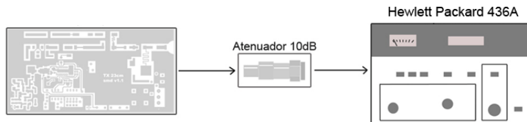
Figura 9.2.2: Esquema de conexión para tomar la medida de potencia.
