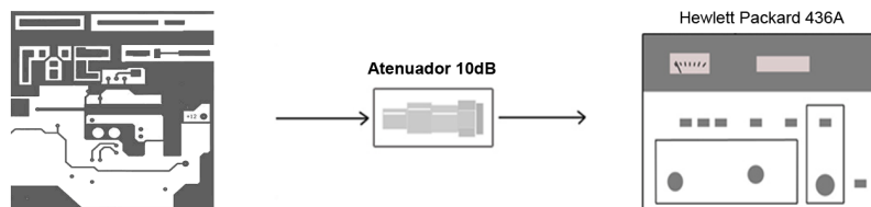
Figura 9.2.1: Esquema de conexión para tomar la medida de potencia.
