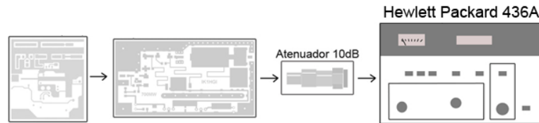
Figura 9.2.3: Esquema de conexión para tomar la medida de potencia.
