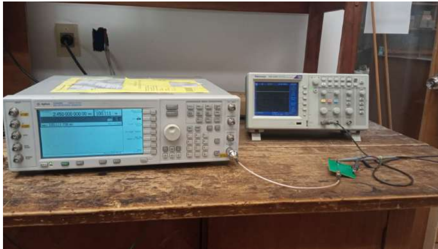
Figura 5.36: Conexión de la prueba de funcionamiento del rectificador.
