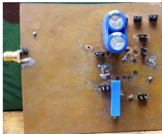
Figura 5.24: Parte inferior de placa completa del segundo diseño con integrado LTC3105.
