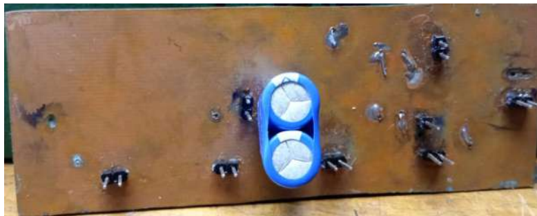
Figura 5.28: Parte inferior de la primera versión fabricada con integrado LTC3108.
