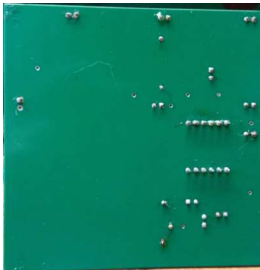
Figura 5.26: Parte inferior de la tercera versión fabricada con integrado LTC3105.
