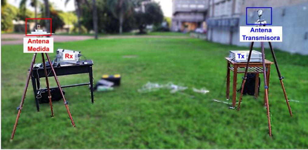
Figura 3.10: Setup de medidas, se resalta la ubicación de la antena medida y la de la antena de transmisión, y los equipos transmisor y receptor.
