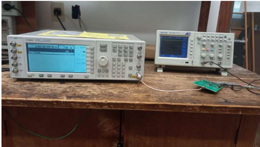
Figura 5.46: Conexión de prueba de funcionamiento final de electrónica.
