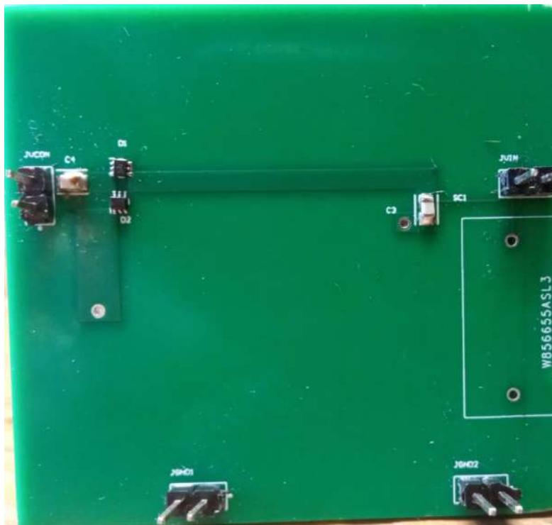
Figura 5.35: Rectificador fabricado en China.
