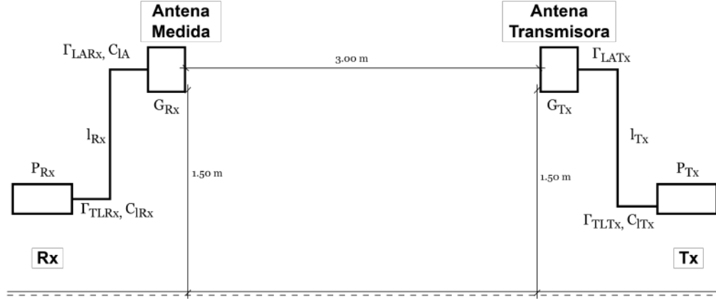
Figura 3.9: Diagrama del setup para medidas de ganancia.
