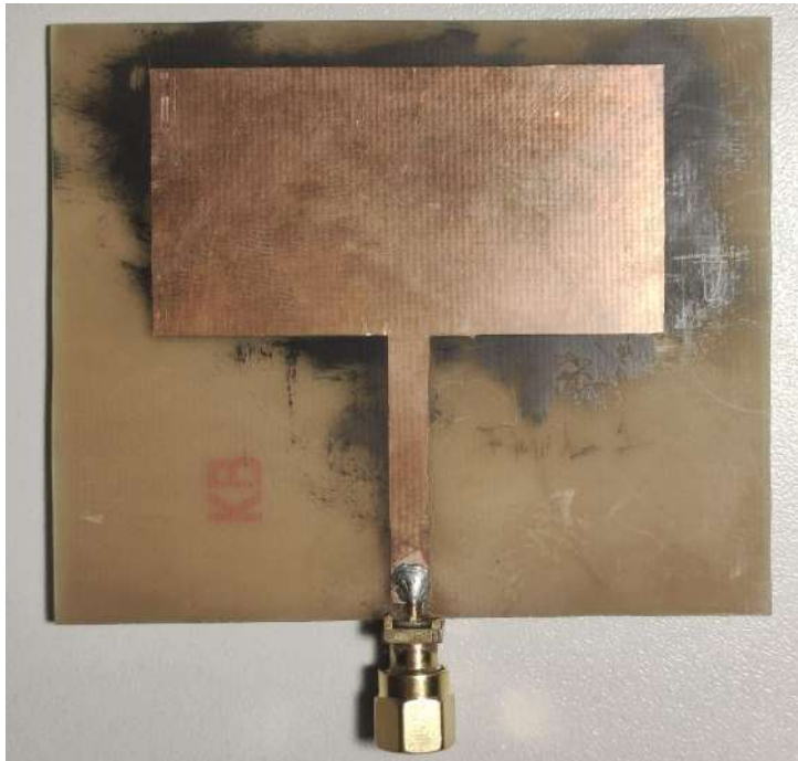
Figura 4.21: Antena de parche fabricada, versión 3.
