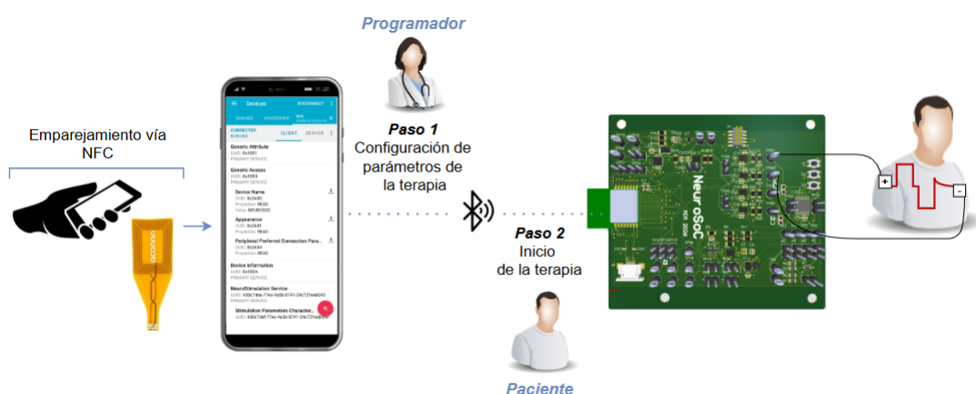
Figura 2.2: Diagrama del flujo de operación del sistema incluyendo las etapas de emparejamiento del dispositivo vía NFC para la conexión Bluetooth, la configuración de parámetros por parte del programador mediante una aplicación móvil y ejecución de la terapia por el paciente utilizando el dispositivo previamente configurado.
