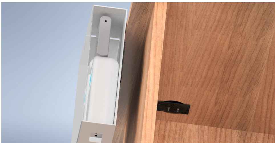
(c) Vista inferior del arreglo, con detalle de la fijación y de los puertos de conexión de los sensores Aeroqual
