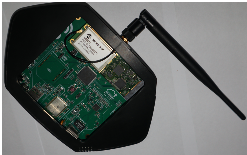
Figura 23: The Things Gateway con antena conectada y sin tapa superior.
