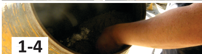
Fig.53. Colocación de insumos en la hormigonera (media bolsa), moldes, pesado de insumos en la balanza.
