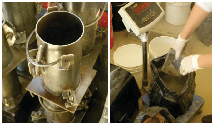
Fig.55. Relleno del cono, medición del diámetro de la mezcla esparcida. Realización del estudio del cono de Abrams (procedimiento para evaluar la fluidez de la pasta).
