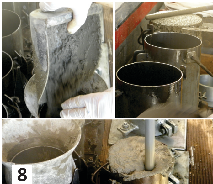
Fig.57. Rellenado de moldes, varillado, alisado de superficie.
