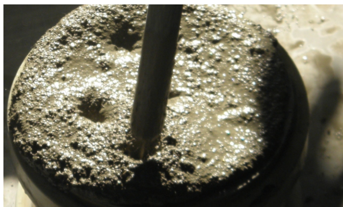
Fig. 31. Vibrado manual con varilla. | Fuente: Elaboración propia.
