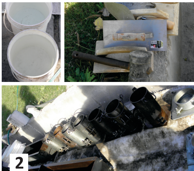
Fig. 46. Moldes, contenedores con agua y herramientas. Preparación del espacio de trabajo: Colocación de moldes (futuras muestras de MHAD), teniendo las herramientas para el correcto vertido del MHAD al alcance (maceta, cuchara de albañil y fretacho). Preparación del resto de los insumos: agua y aditivos.
