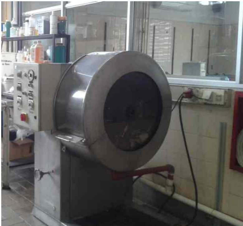
Fotografía del fulón en funcionamiento tomada en el LATU durante el proceso.
