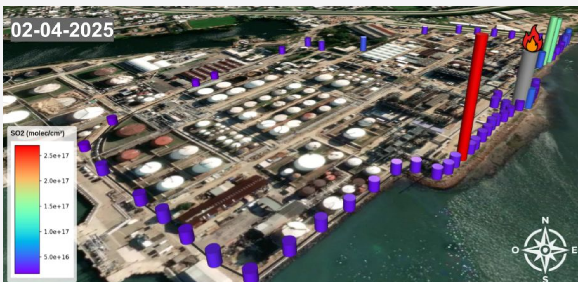
Fig. 2: Ejemplo de dSCD de SO 2 obtenidas. Viento de velocidad 3.045 m/s, NNO.
