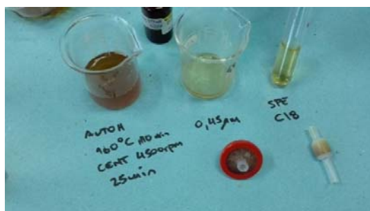
Figura 7-20. Procedimiento realizado al licor del tratamiento hidrotérmico para la determinación de distribución de pesos moleculares de los carbohidratos disueltos en el mismo.
