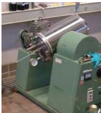
Figura 6-3. Reactor circular de 15 L donde se colocaron 4 cápsulas metálicas para los ensayos experimentales.
