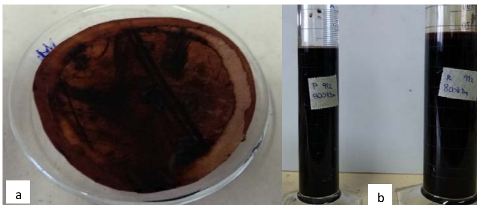
Figura 14-9. a) Membrana de PVDF de 800.000 Da luego del ensayo. Las marcas más oscuras muestran zonas de la membrana donde se dañó el material filtrante. b) Permeado y retenido luego del ensayo.
