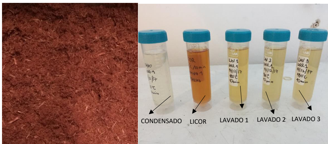
Figura 8-3. Izquierda: Sólido resultante de la explosión a 180 °C de aserrín de Eucalyptus Grandis . Derecha: condensado recogido de salida del condensador, licor extraído de la primera prensada, agua de lavado de los 3 lavados realizados, correspondientes a explosión de vapor a 180 °C.
