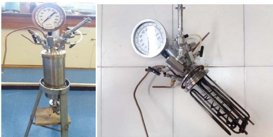
Figura 10-1. Reactor Parr utilizado para la realización de las experiencias de extracción. A la derecha se muestra un detalle del agitador utilizado y del sistema de enfriamiento con serpentín.
