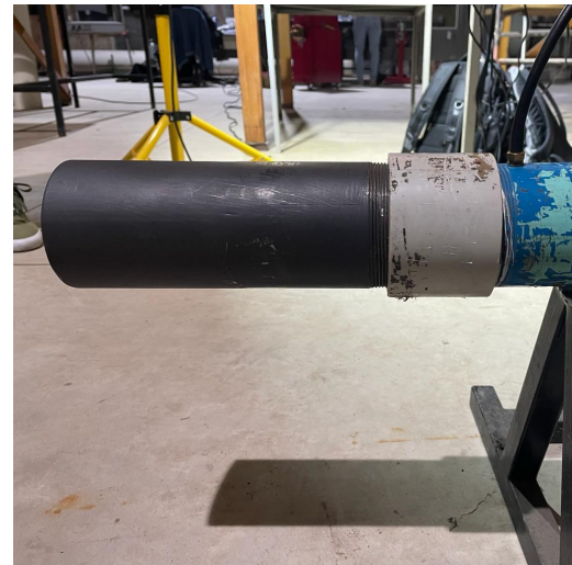
(b) Tramo final de la tubería, posterior a la malla, y toma de presión.
