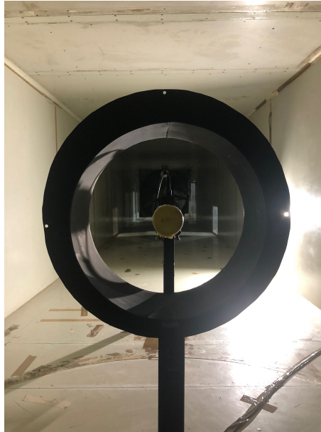
Figura 4.2.5: Rotor al finalizar el ensayo de la envolvente Falange-Recto.
