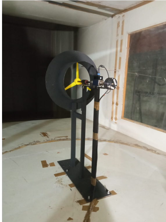
Figura 4.2.4: Banco de ensayo, envolvente y rotor montados en túnel.
