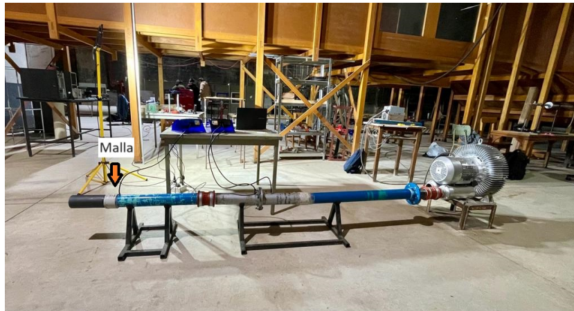
Figura A.9.2: Imagen tomada de el banco de ensayos, señalando la zona donde se coloca la malla.
