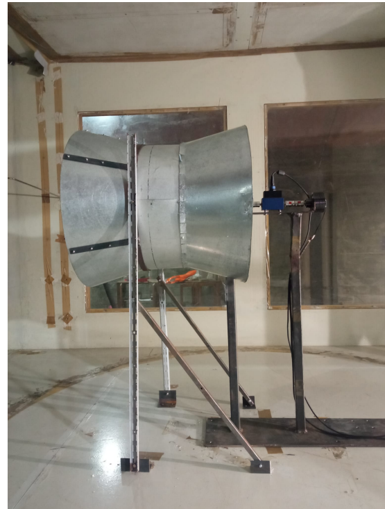
(b) Ensayo de Cono-Recto con difusor.
