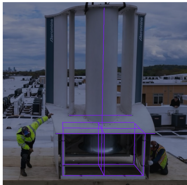
Figura 4.3.1: Foto utilizada para obtener relaciones entre las dimensiones del Aeromine. La foto utilizada fue extraída de la página de LinkedIn de Aeromine Technologies, Inc. ( https://www.linkedin.com/company/aeromine-technologies/ ).
