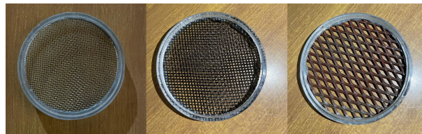
Figura 4.3.15: Mallas pegadas al soporte acrílico.
