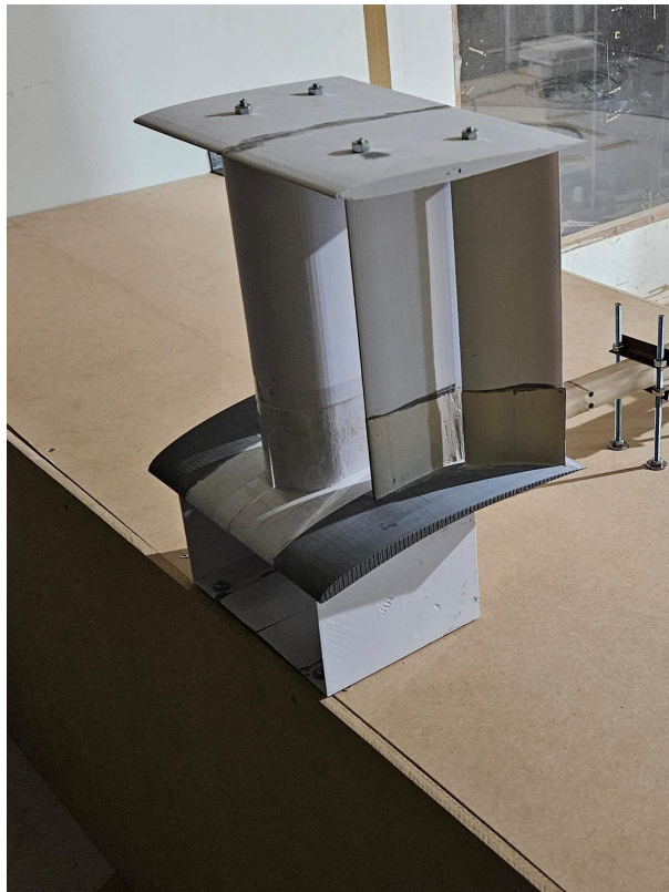
Figura 4.3.18: Modelo Aeromine montado sin separación del "techo".
