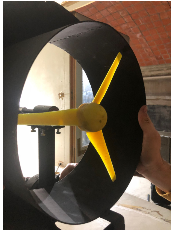
Figura 4.2.3: Rotor utilizado para el ensayo.
