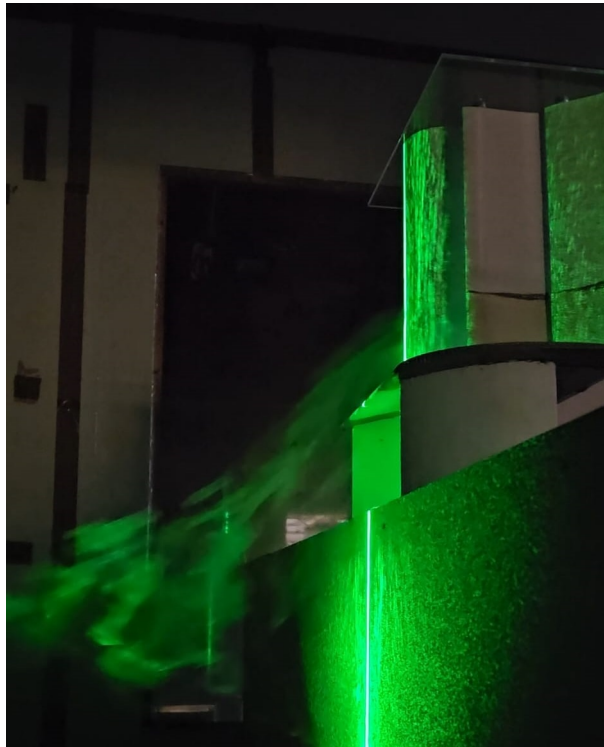
Figura 4.3.19: Líneas de flujo marcadas por el humo en ensayo contra el piso.
