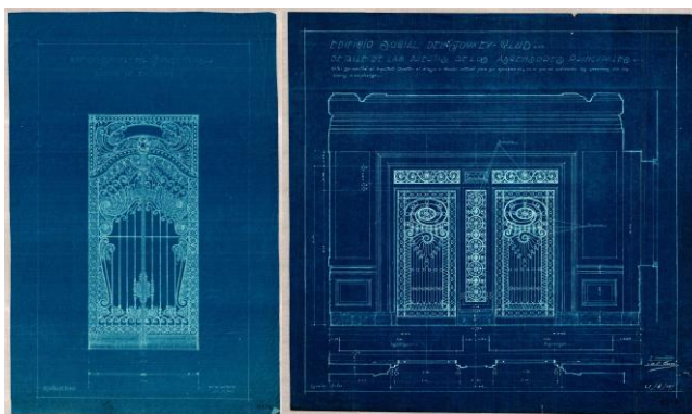
52-53. Detalle de puerta de entrada y puertas de ascensores principales 71
