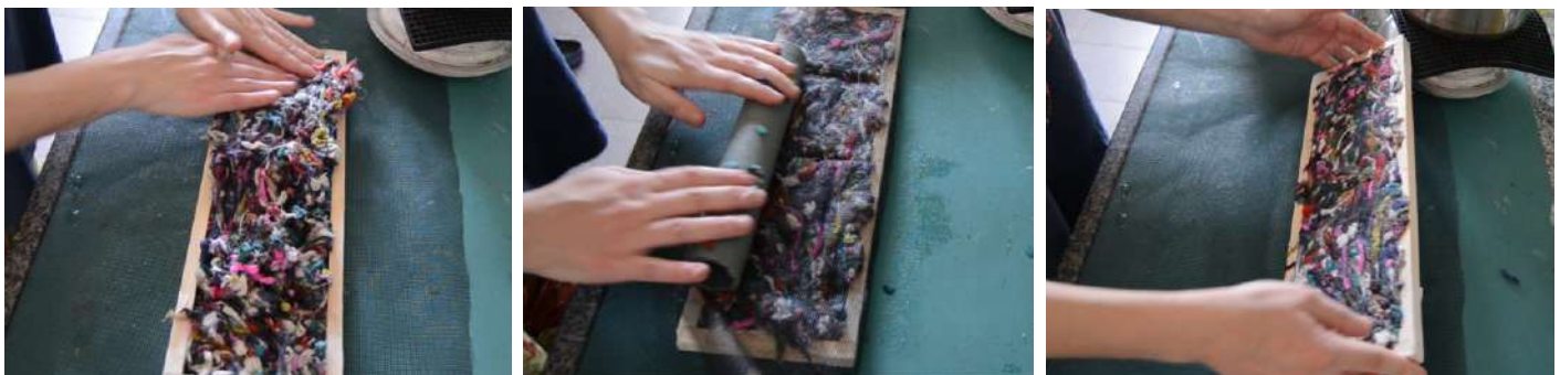
Figura CXIV. Colocación del material en molde y amasado
