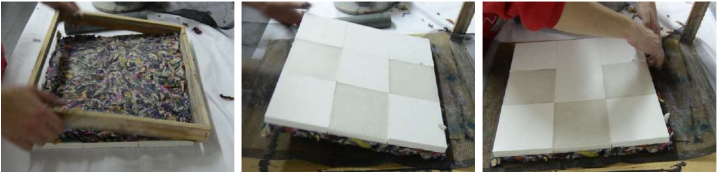
Figura CCIX. Proceso de desmolde del panel
