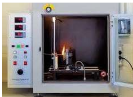
Figura CCXVII. Ejemplo cámara de combustión
