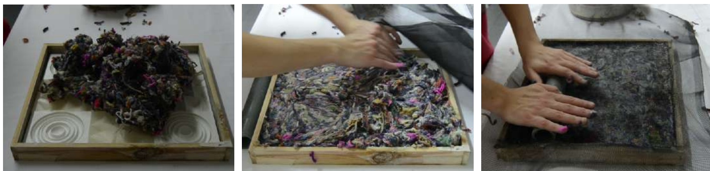
Figura CCVIII. Proceso de armado de panel con molde
