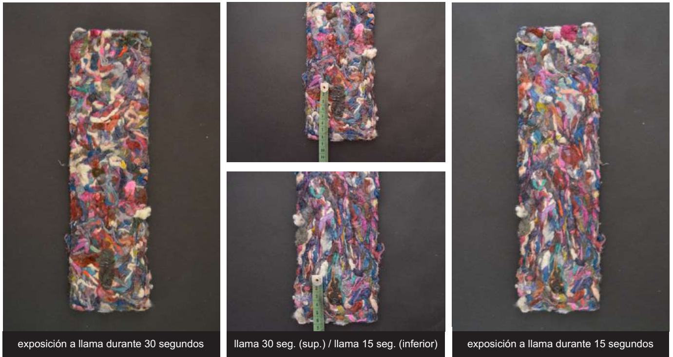
Figura CCXXI. Resultados ensayo sobre superficie expuesta
