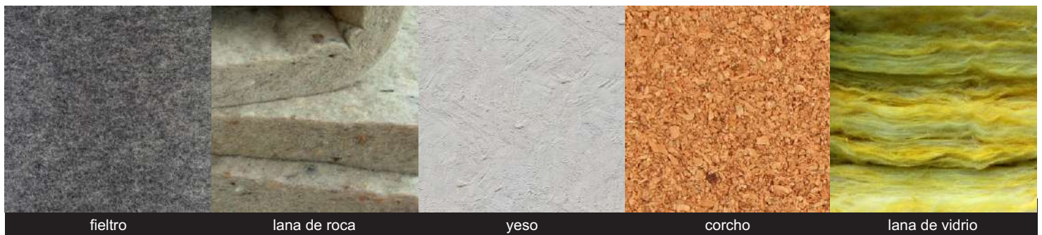
Figura XII. Materiales absorbentes acústicos
