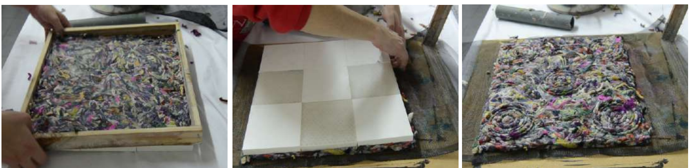
Desmolde del panel con trabajo superficial
