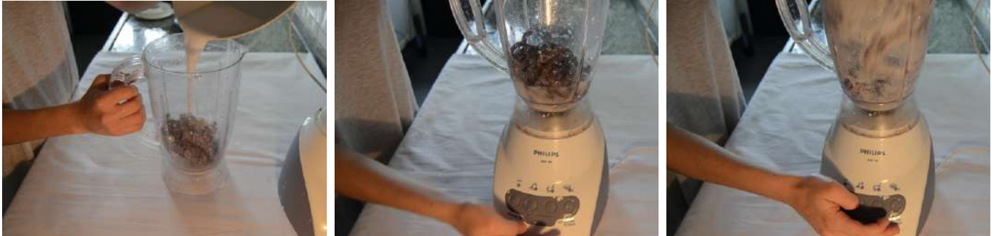
Figura CXXVII. Incorporación de cola vinílica y agua
