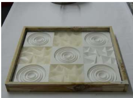
Figura CCVII. Molde para paneles de 30 x 35 x 1,5 cm terminado
