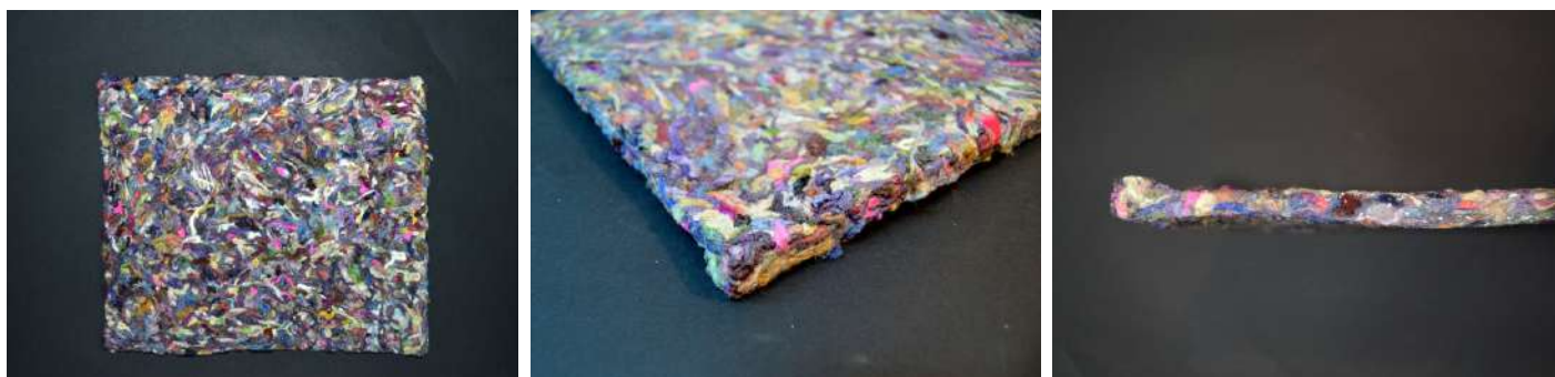
Figura CXC VII. Muestra en bioplástico y lana de 30 x 35 x 1,5 cm
