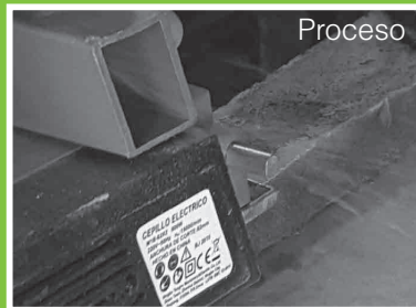
Figura 77 - Proceso cepillado con cepillo manual
