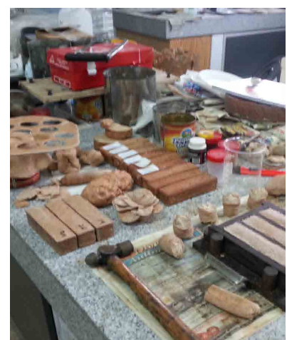
Retiro de piezas luego de prueba de inmercion en agua
