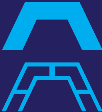
Figura 104 - Ejemplo de pieza extruída maciza y hueca
