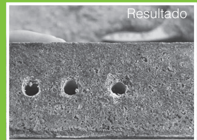
Figura 79 - Proceso de perforado mediante taladro de banco con mecha para madera
