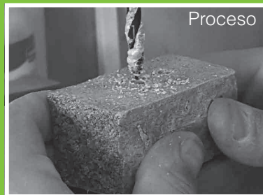
Figura 79 - Proceso de perforado mediante taladro de banco con mecha para madera
