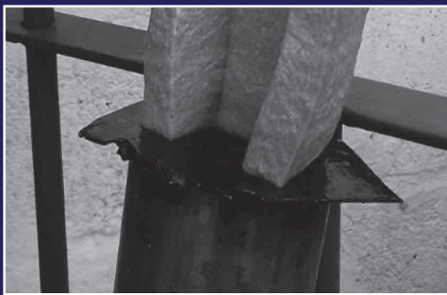
Figura 108 - Expansión del material al salir de la boquilla extrusora.
