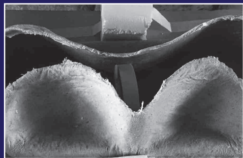
Figura 116 - Utilización de soportes durante el secado.
