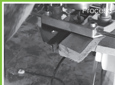
Figura 76 - Proceso fresado con router manual
