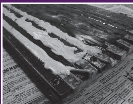
Figura 47 - Proceso de fraguado de muestras con carga
