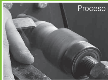
Figura 73 - Proceso de torneado con torno de 2 puntas
