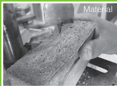
Figura 74 - Proceso de perforado mediante taladro de banco con mecha de paleta
