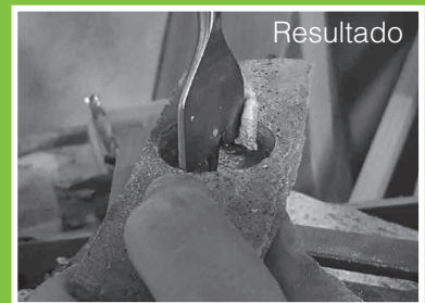
Figura 74 - Proceso de perforado mediante taladro de banco con mecha de paleta
