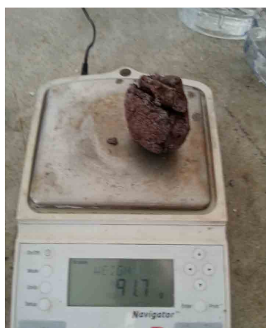
Retiro de piezas luego de prueba de inmercion en agua
