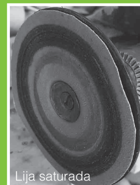
Figura 81 - Problemas encontrados durante los procesos de mecanizado
