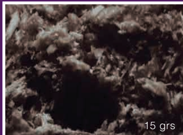
Figura 54 - Adición de aserrín en MEC
