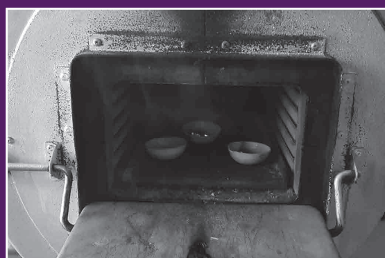
Figura 61 - Retiro de muestras de Mufla
