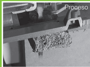
Figura 75 - Proceso corte con sierra caladora manual
