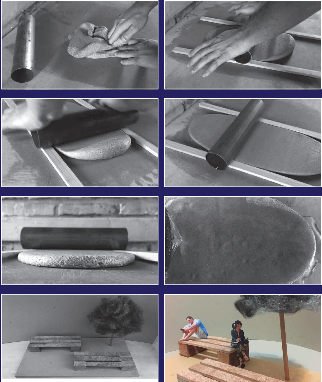
Figura 100 - Proceso manual de generación de láminas calandradas
