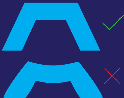
Figura 105 - Diferencia entre piezas con y sin puelverzación de agua
