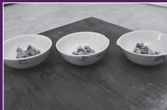
Figura 60 - Muestras para quema en Mufla
