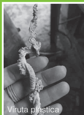
Figura 81 - Problemas encontrados durante los procesos de mecanizado
