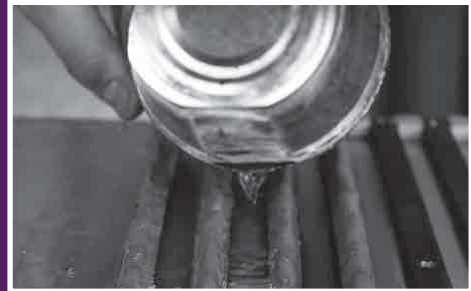
Figura 41 - Adición de solvente luego del vertido del material
