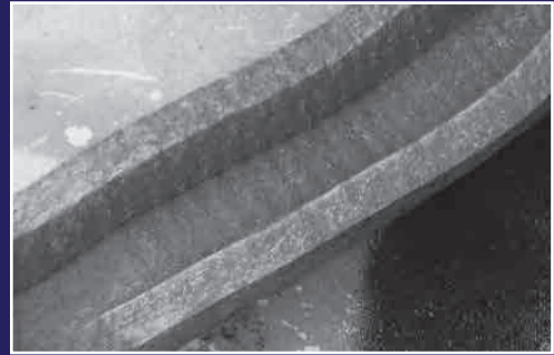
Figura 109 - Marcas y deformaciones por diferencias de presión durante el proceso.
