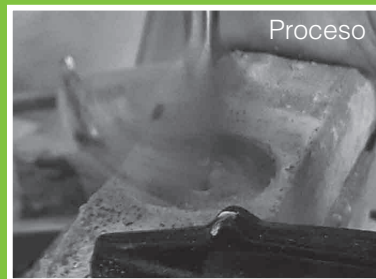
Figura 74 - Proceso de perforado mediante taladro de banco con mecha de paleta
