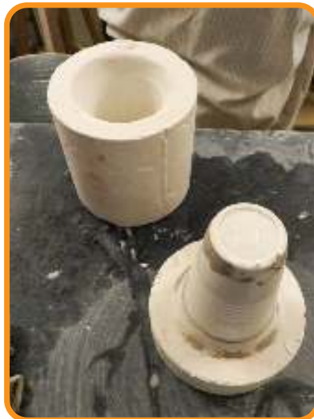
Molde de bloque/Molde maestro
