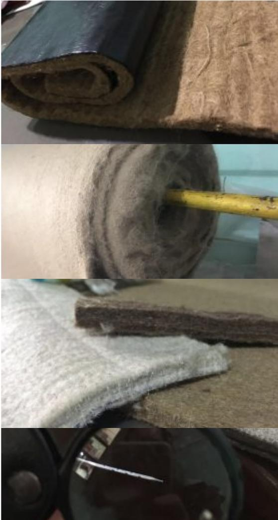
Fotografías: Fieltro de yute con termoplástico, bobina de yute, diferentes tipos de fieltro y detalle con lupa de una púa.
