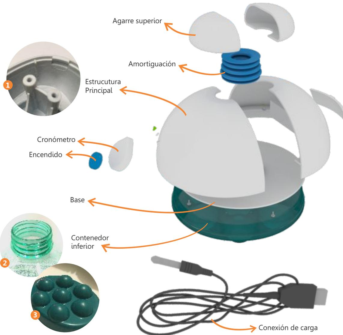
Tanto el agarre superior como la estructura principal se conforman por dos carcasas de polipropileno, modelado por inyección, que se encastran. La base de la estructura principal también es de polipropileno.
