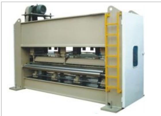
Máquina Punzonadora, para producción de fieltro seco a escala industrial.
