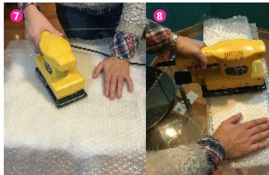
7 Se aplica la herramienta sobre el fieltro por períodos de varios minutos, verificando la consistencia del fieltro.
