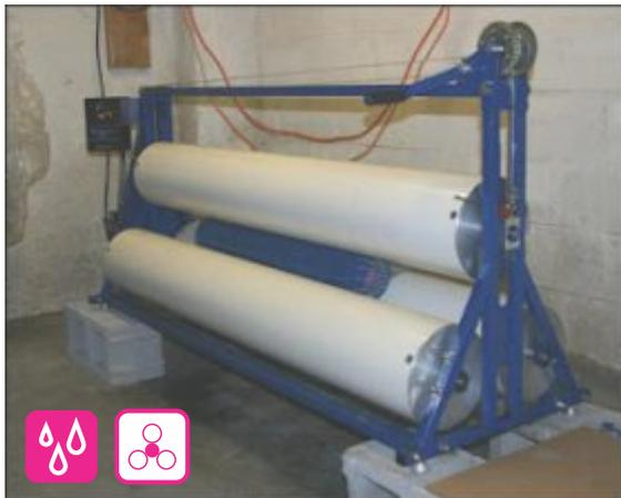
Ejemplo de Afieltradora de cilindro, del Proceso húmedo.
