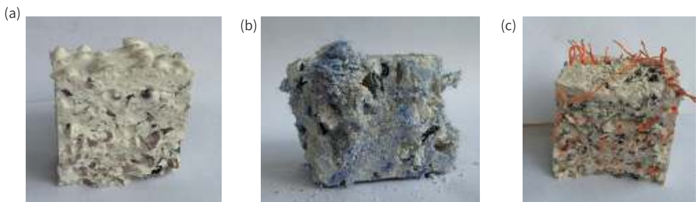
Figura 30: Fotografías de muestras con granulometría "B". (a) Muestra de silicona y poliestireno. (b) Muestra de yeso y lana. (c) Muestra de caucho y plastillera. Fuente: Autoría propia.
