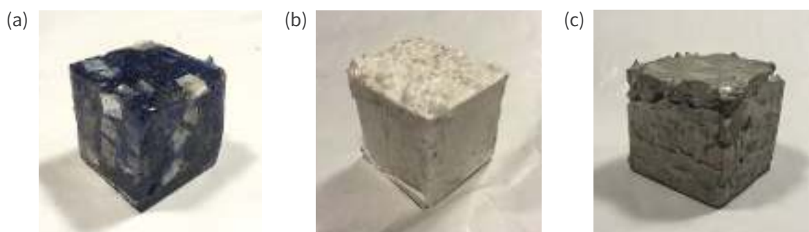
Figura 35: (a) Muestra resinosa. (b) Muestra gomosa. (c) Muestra de hormigón. Fuente: Autoría propia.
