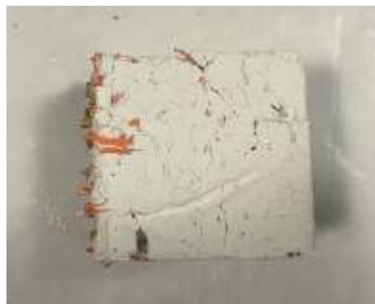
Figura 32: Fotografía de muestra con cal. Se observa la fisura en su superficie.
