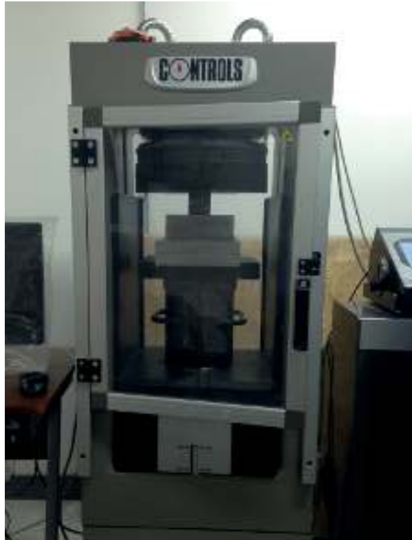
Figura 17: Equipamiento de laboratorio (prensa de compresión) que se utiliza para realizar los ensayos. Fuente: Autoría propia (Diciembre, 2016).
