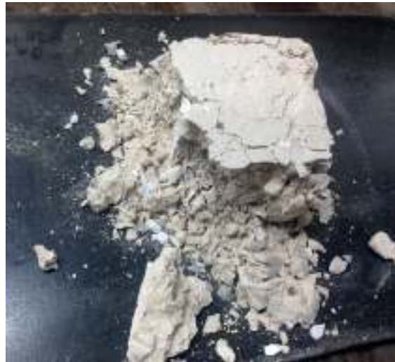
Figura 33: Fotografía de muestra de arcilla. Se observa el colapso total debido al quiebre. Fuente: Autoría propia.
