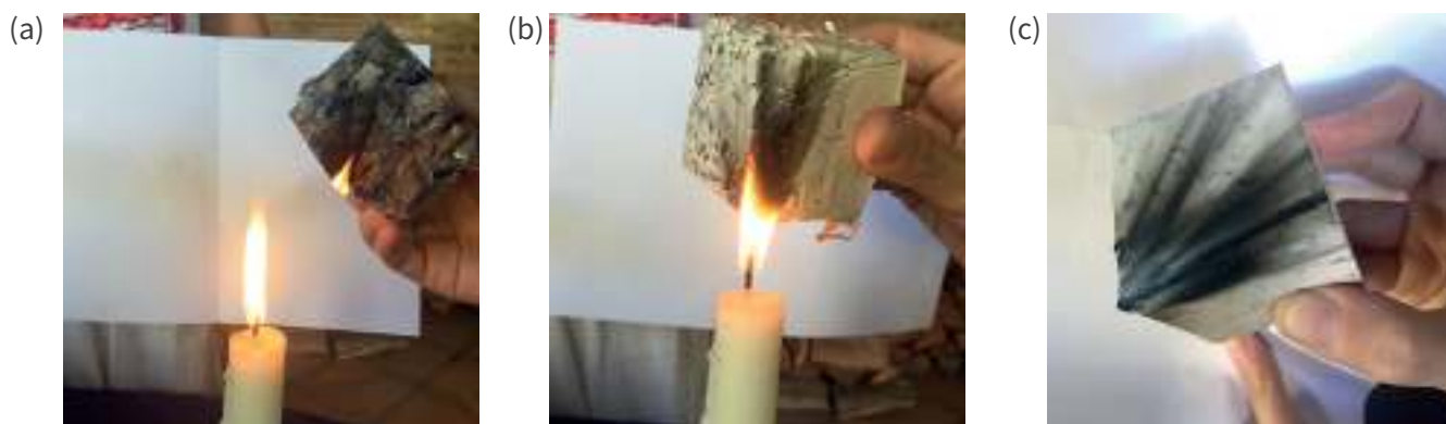
Figura 21: (a-b-c) Muestras durante el ensayo de resistencia a la llama. Fuente: Autoría propia (Diciembre, 2016).
