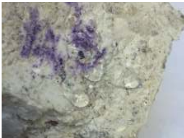
Figura 28: Muestra de silicona y cal: impermeable. Fuente: Autoría propia.
