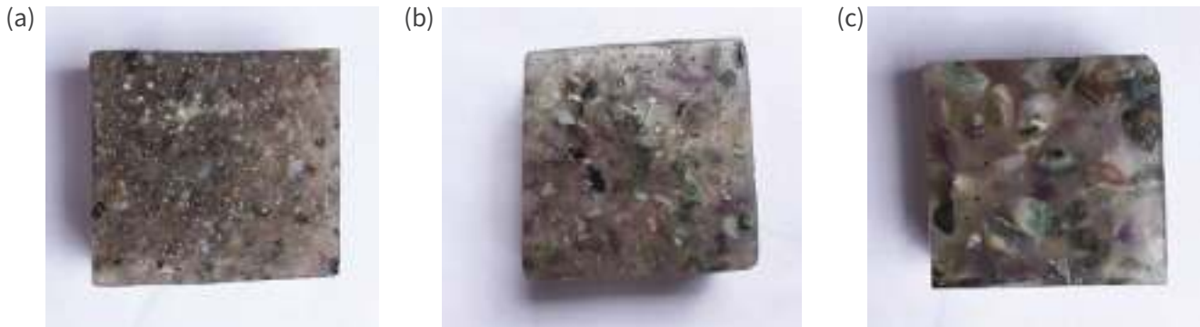
Figura 65: (a) MA: Muestra de resina y piedra de granulometría A. (b) MB: Muestra de resina y piedra de granulometría B. (c) MC: Muestra de resina y piedra de granulometría C. Fuente: Autoría propia.
