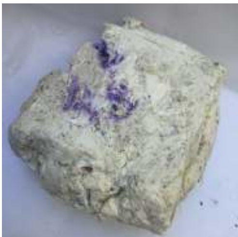
Figura 24: Muestra de silicona, cal, caña y piedra luego del ensayo. Se observa que si bien quedo "aplastada", la estructura no sufrió colapso estructural. Fuente: Autoría propia (Diciembre, 2016).
