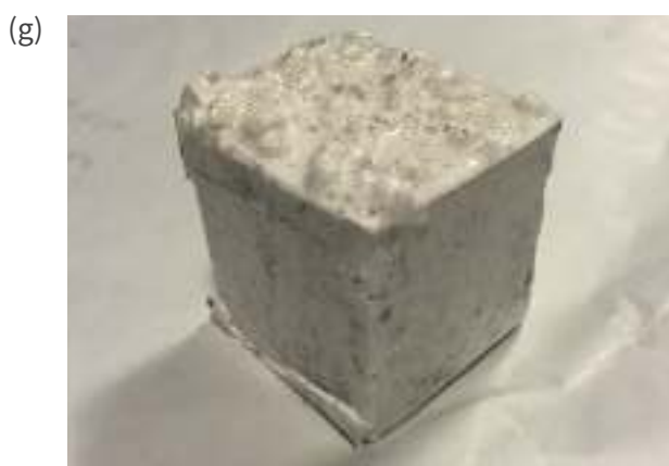
Figura 27: Fotografías de muestras clasificadas según tipos de rotura. (a) Muestra de sílica y cal: baja resistencia, deformación y colapso. (b) Muestra de cal: muy baja resistencia y colapso. (c) Muestra de yeso: baja resistencia y colapso. (d) Muestra de hormigón: resistencia media y colapso. (e) Muestra de resina: alta resistencia y quiebre. (f-g) Muestra de sílica: deformación y recuperación de la forma original.
