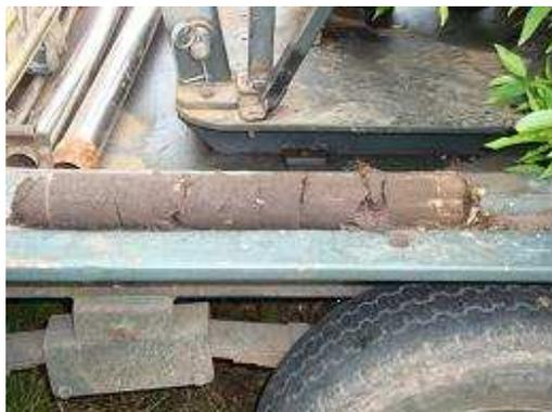
Figura 5 Columna de suelo extraída por el taladro neumático
