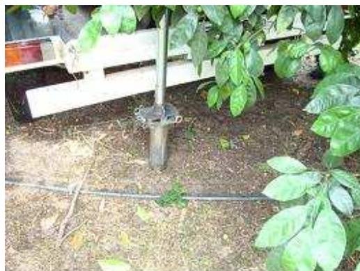
Figura 4 Taladro neumático ingresando en el suelo
