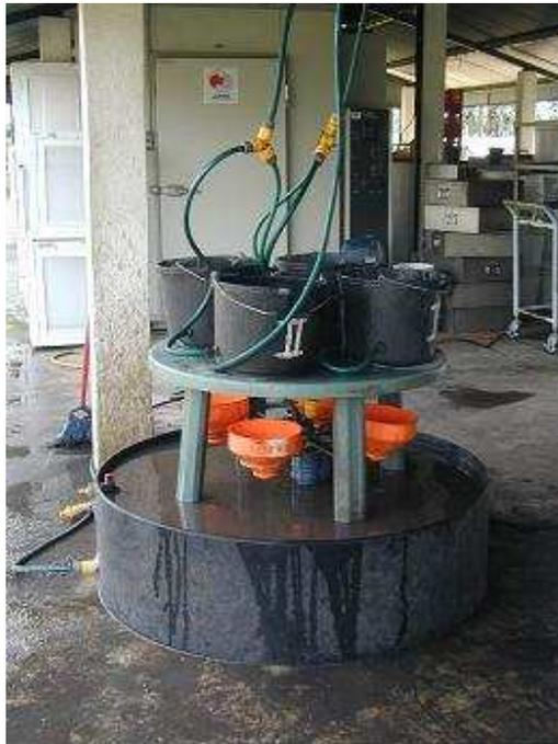
Figura 8 Vista del equipo Delta T tipo RWC, utilizado para lavar las raíces
