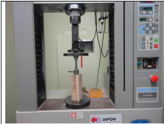
Fig. 23. Máquina Universal Minebea. Ensayo de dureza en sentido paralelo al grano
