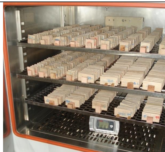
Fig. 16. Probetas de contracción en estufa Yamato DK 610
