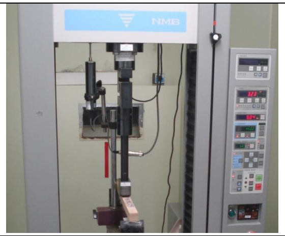
Fig. 20. Celda de carga, extensómetro sobre travesa
