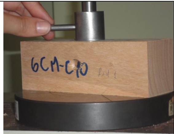
Fig. 24. Ensayo de dureza en sentido perpendicular al grano. Vista del accesorio
