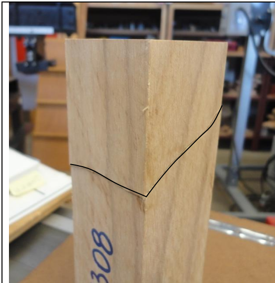
Fig. 25 Forma tipo de ruptura en compresión paralela al grano
