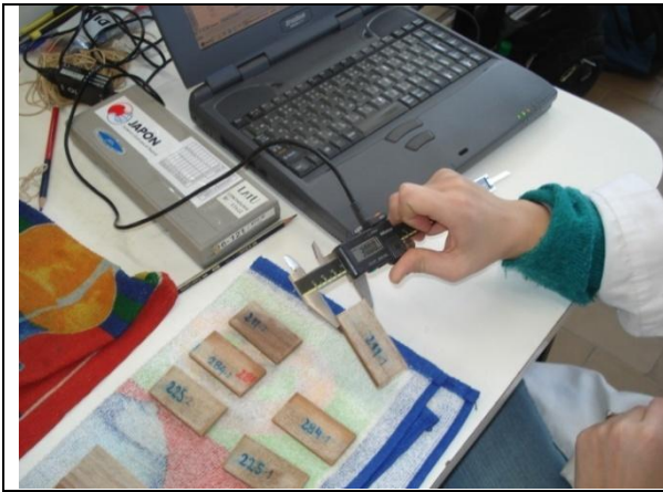
Fig. 13. Medición de probetas con calibre
