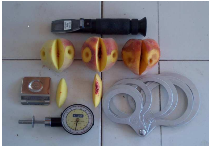
Foto No. 5: Instrumentos utilizados en la determinación de la calidad de los frutos.
