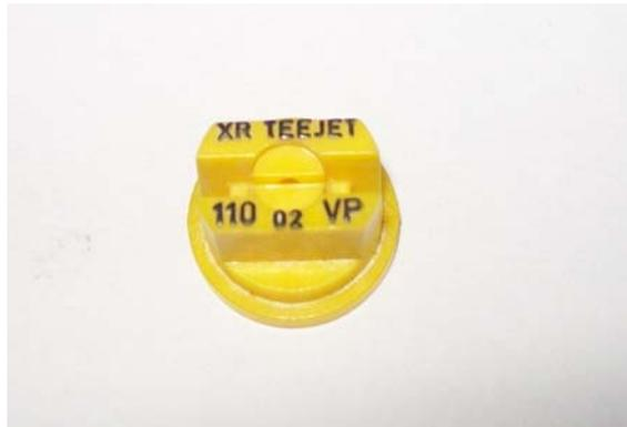
Figura No. 5: boquilla de abanico plano rango extendido (XR).
