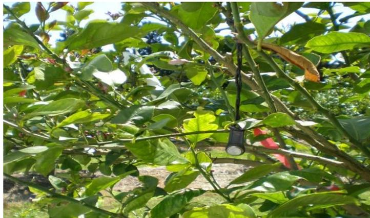
Figura 9. Sensor de temperatura y humedad relativa colocado en las plantas.
