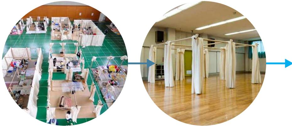
Se trata de un diseño de paneles divisores implementado en Japón en el año 2011 para la utilización luego frente a situaciones de emergencia. El diseño se encuentra desarrollado por el grupo de arquitectos Shigeru Ban. Consiste en una estructura realizada en bambú encastrada a la cual se le endosan cortinas.
