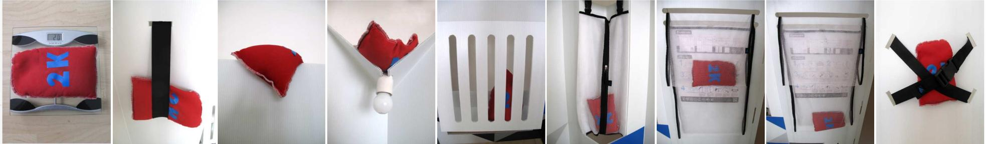
Para la realización de los ensayos de carga se llena una bolsa con dos kilos de arena y se coloca en alforjas, cinchas y pliegues. A su vez se prueba en las que se cree son las partes más comprometidas, debido a que son piezas terminales con muchos cortes o pliegues.
