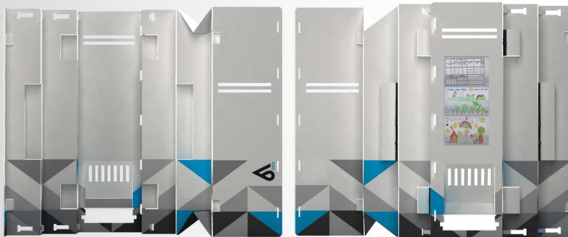
Renderizado de panel total. Se detectan errores como que el folio debe quedar adentro del panel cerrado para evitar roturas por traslado. El calado para libros es demasiado grande, generando puntos críticos en los bordes. Minimizar cantidad de calados. Cerrado de alforjas por delante y no por atrás.
