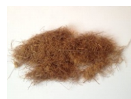
Fibras de bambú extraída mediante desgarradoras.
