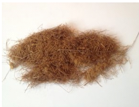
Fibras de bambú extraída mediante desgarradoras.
