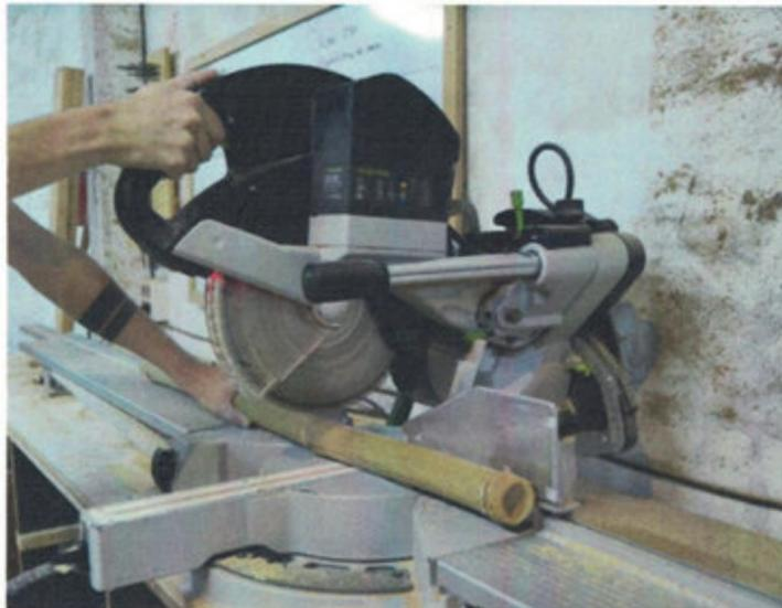
Este paso se puede realizar tanto con ingletadora eléctrica o con una sierra manual, siempre cuidando que el corte sea parejo y ortogonal.
