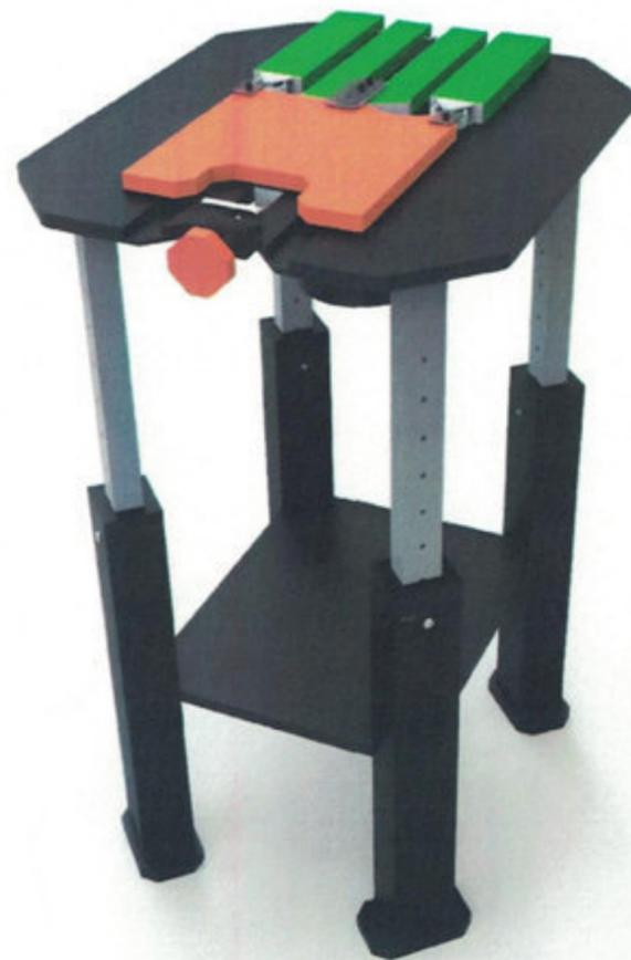
Está compuesta por una mesa con un trompo de mano acoplado en la parte inferior y con la fresa saliendo por la parte superior. Además en la parte superior cuenta con una guía regulable (pieza anaranjada) y cuatro presionadores (piezas verdes) que sostienen a la caña sobre la guía.
