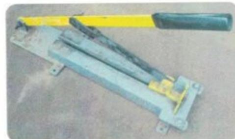
A continuación se muestran máquinas manuales utilizadas para la producción de palillos o inciensos. Se trabaja con tramos cortos y se colocan en la ranura y ejerciendo presión se la hace correr por un filo (similar a un corta papas)
