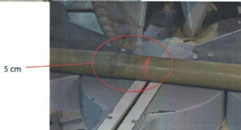
Marcar un extremo de la caña según el diámetro de la misma y la cantidad de latillas que se quiera extraer.
