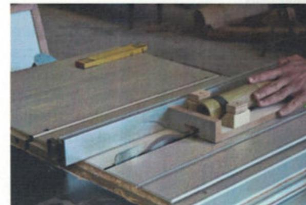
Este soporte sirve para alojar el segmento de caña, sujetarlo y pasarlo en línea recta por la sierra circular, manteniéndose apoyado sobre la guía que todas las sierras suelen tener.
