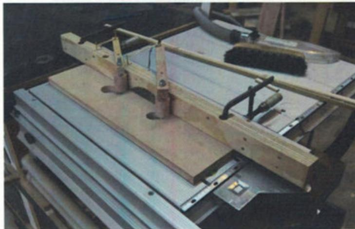
En este caso se desplaza la guía original de la máquina, se baja el disco por debajo del nivel de la mesa y se coloca una guía de madera. Es necesario calcular que la guía deje 1 milímetro aprox. de sierra sobresaliente de la guía de madera, se fija dicha guía a la original y se enciende la máquina para poder subir el disco lentamente.
