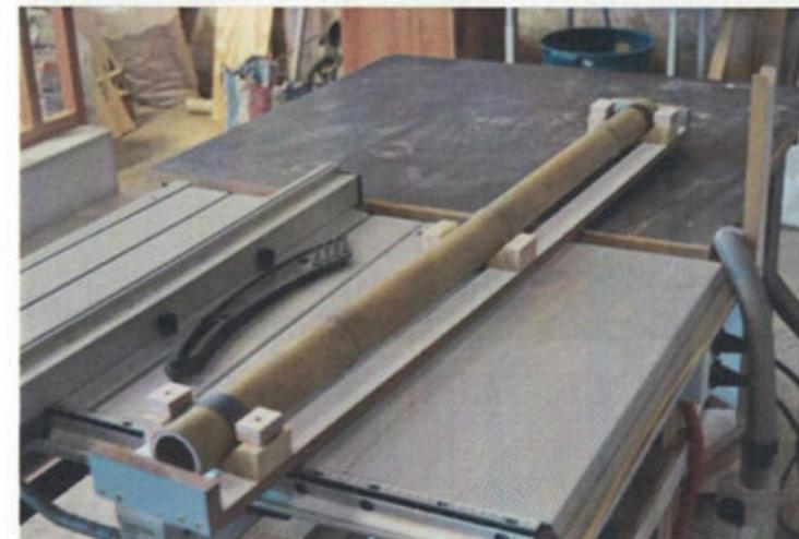
En esta imagen se puede ver los puntos de sujeción ubicados lejos de los nudos, luego de algunos cortes, la caña tiende a deformarse en esos puntos.
