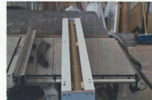
Para poder cortar longitudinalmente la caña es necesario calcular por donde debe pasar la sierra dependiendo el ancho de latilla que se necesite o permita e material. Esto es debido a que para una latilla es necesario realizar dos pasadas por la sierra, una de cada lado del soporte
