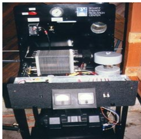
Figura 1.5 - El sistema de la celda de combustible está ubicado dentro de una torre de comunicaciones y alcanza una eficiencia del 50%.
