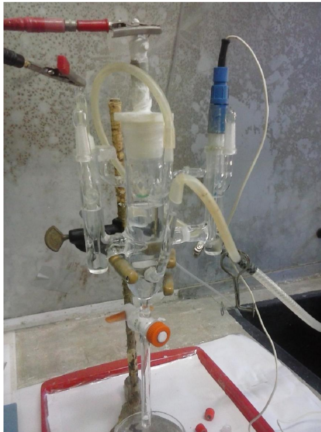
Figura 3.1 –Sistema electroquímico utilizado para realizar las medidas.
