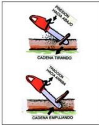
Figura No. 21. Lado de corte de la espada según posición de trabajo.
