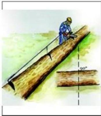
Figura No. 27. Marcación de puntos de corte antes de iniciar el trozado.
