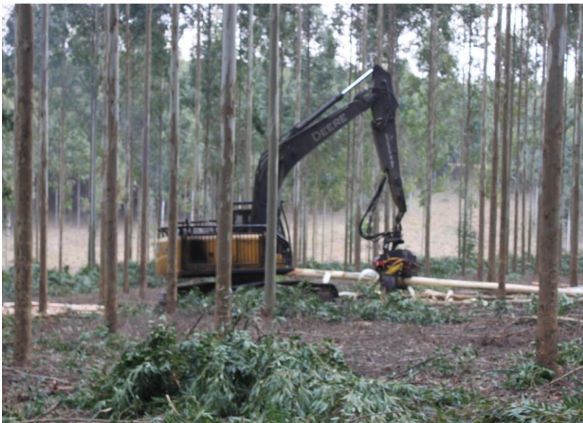
Figura No.7 Excavadora John Deere 200D con cabezal Waratah H 27
