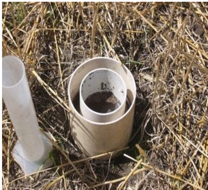
Figura No. 1. Representación de la medición de infiltración en el campo. El anillo interior contiene 450 ml de agua. El nivel de agua en el anillo exterior es igual al nivel en el anillo interior. Se mide el tiempo necesario para la infiltración total de agua en el anillo interior
