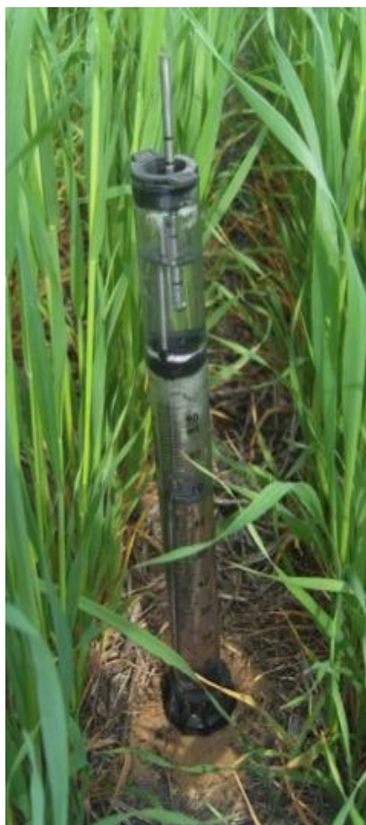
Figura No. 2. Medición de la conductividad hidráulica en el campo utilizando el infiltrómetro mini disco
