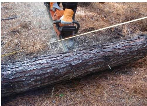
Figura No. 7. Corte del fuste en trozas.
