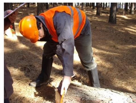
Figura No. 8. Medición de diámetro inferior de trozas.
