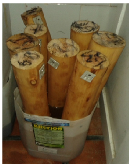
Figura 4. Primer tratamiento: Ascensión simple con una solución de Boro al 2%.
