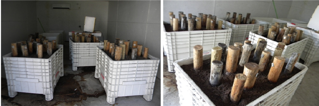
Figura 8. Instalación del ensayo de campo acelerado.
