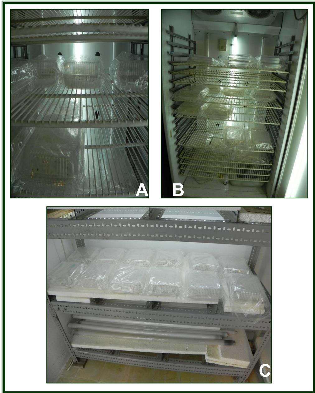
Figura No. 8. Cámaras de germinación utilizadas con las semillas de *Psidium cattleianum*. A y B - Germinador de temperatura alternante. C - Germinador utilizado para los tratamientos con temperatura constante.
