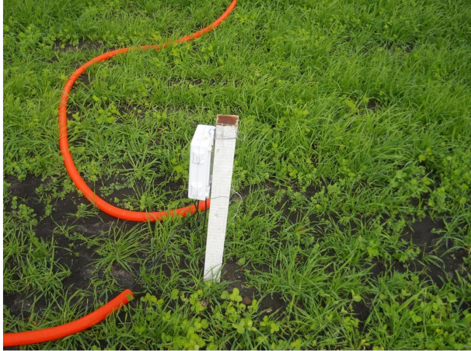
Ilustración No. 1. Sensor FDR ubicado en el sitio experimental.
