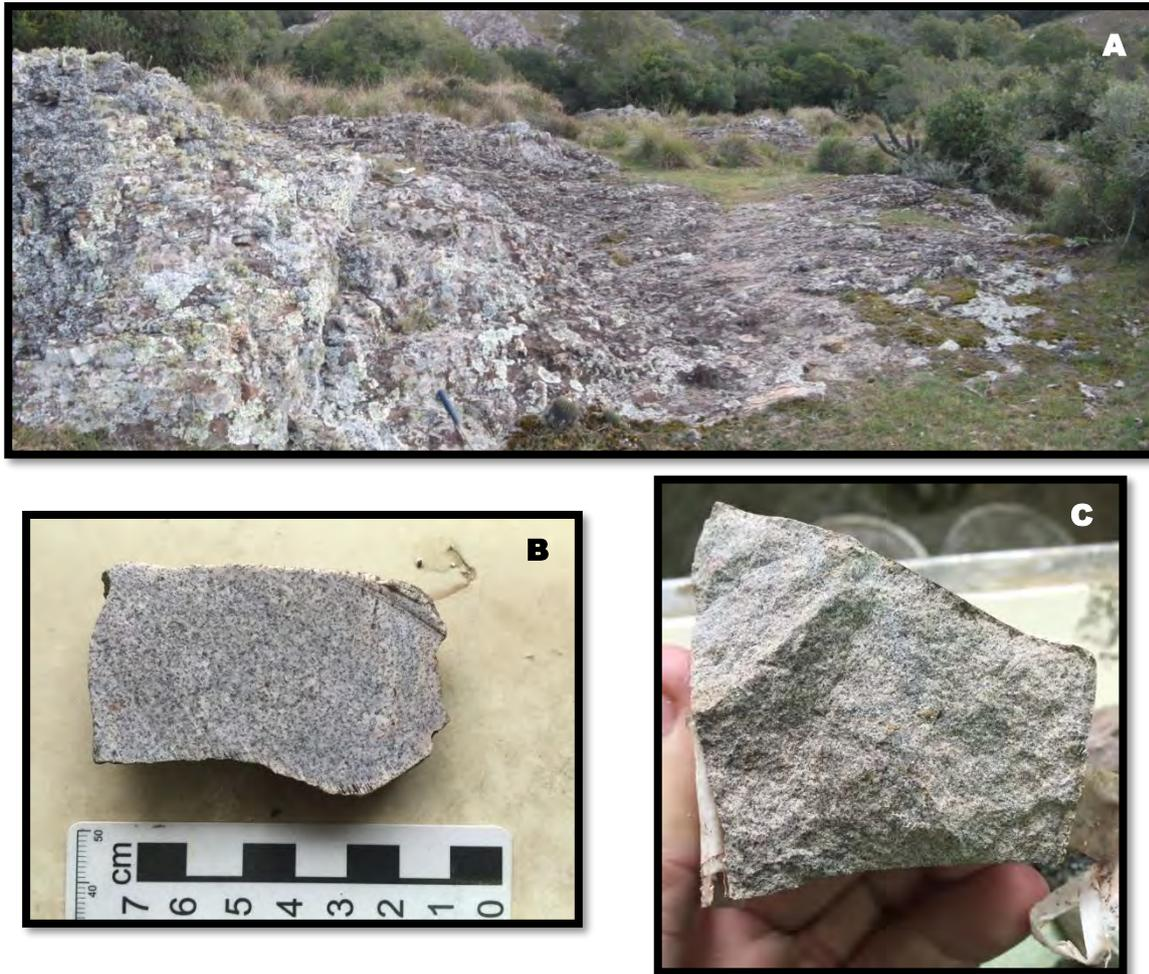
**Figura 19** - A Foto de afloramiento de las traquitas al pie del cerro Marmarajá, B y C. Foto de detalle de las muestras de mano de las traquitas.
