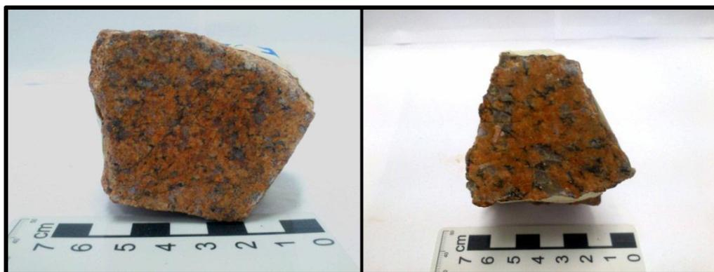
*Figura 11. Imágenes de muestra de mano del granito Guazunambí. Izquierda la muestra más alejada de la zona de cizalla Sierra Ballena. Derecha la muestra más cercana a la zona de cizalla, obsérvese la diferencia en deformación.*
