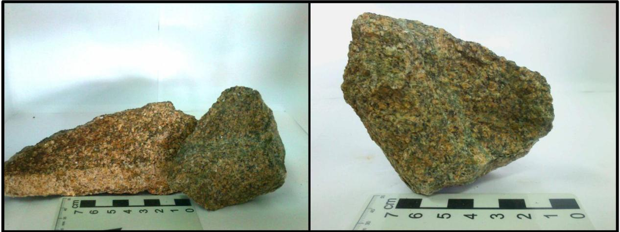
Figura 20. Imágenes de muestra de mano de la variación de la facies de monzogranito rosado con mayor proporción de biotita. A la izquierda granito alterado en contacto con un dique aplítico. A la derecha granito con mayor alteración.
