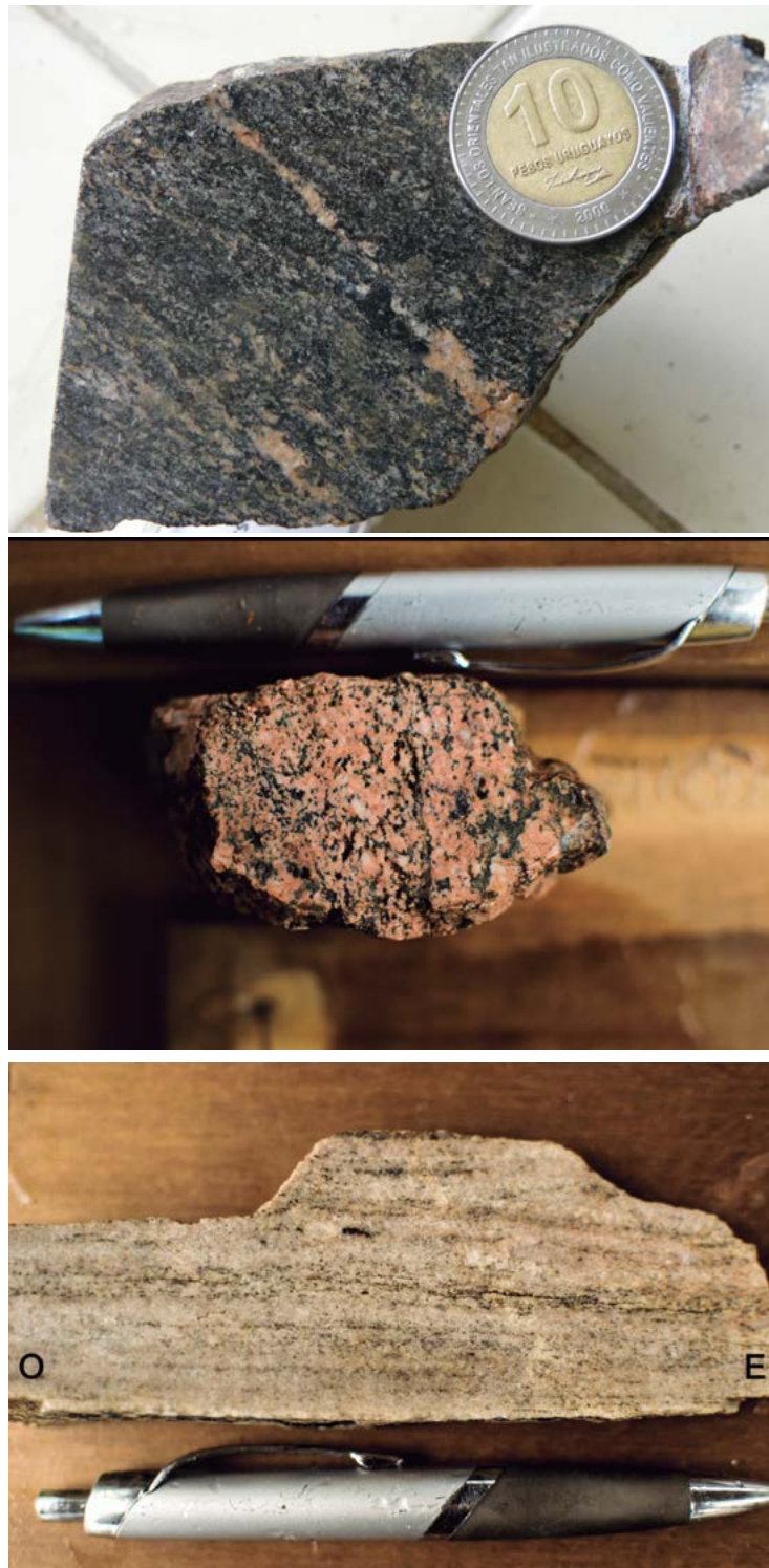
Figura 26. Muestras de mano de rocas del Dominio Oriental. Arriba, gneis con lentes ricos en biotita y otros ricos en cuarzo y feldespato. Centro, granito. Abajo, granito foliado ca. E-O.
