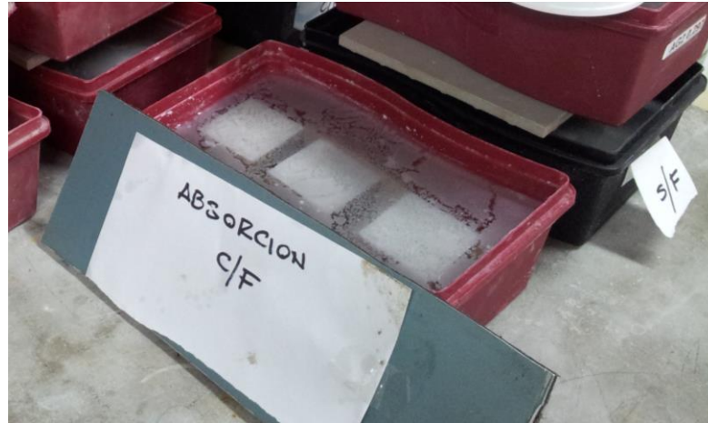
Figura 3.29 – Período de curado de las muestras para el ensayo de absorción.
