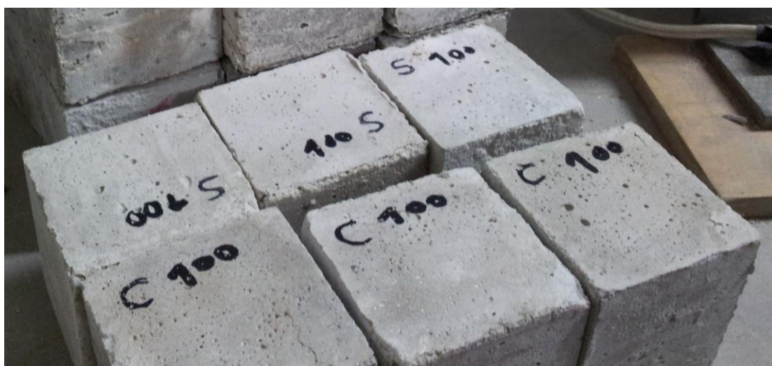
Figura 3.40 – Muestra a temp. 100 °C despues del ensayo a compresión – las muestras con y sin fibra óptica mantienen la coformación cúbica.
