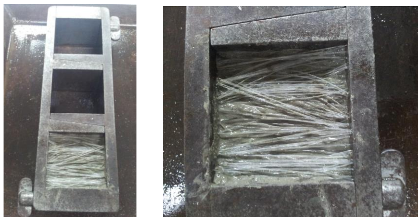
Figura 3.16 – División de las cantidades de fibra óptica para la incorporación por capas en los moldes
