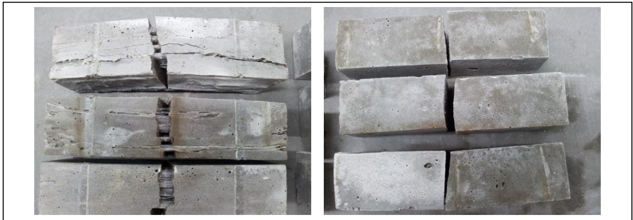
Figura 3.27 – Muestras en el ensayo de resistencia a la flexión.
