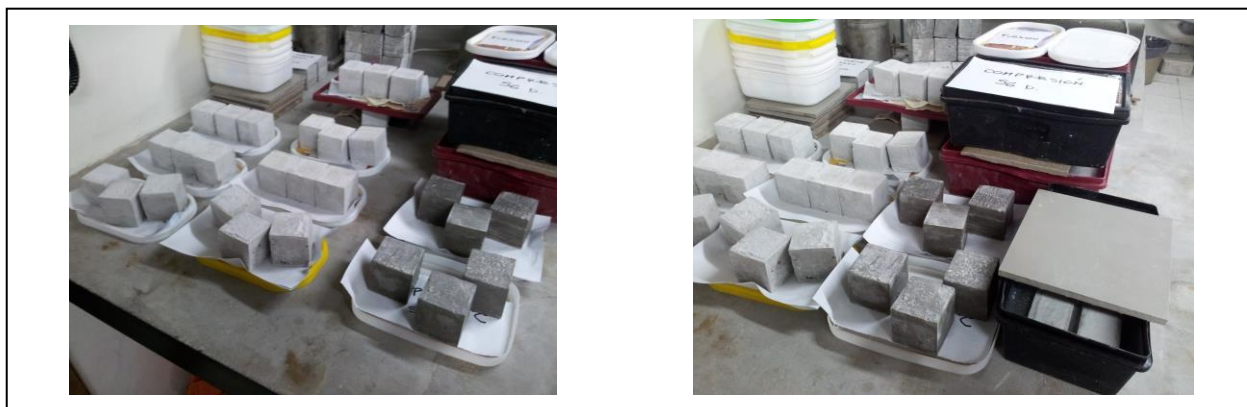
Figura 3.22 – Muestras para realizar ensayos y otras en el proceso de curado.
