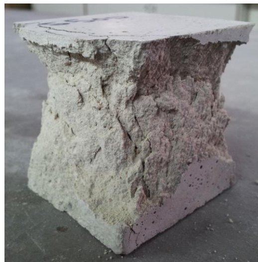
Figura 3.46 – Muestra a temp. 500 °C SIN fibra óptica después del ensayo a compresión
