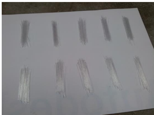
Figura 3.16 – División de las cantidades de fibra óptica para la incorporación por capas en los moldes
