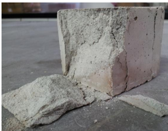
Figura 3.43 – Muestra a temp. 400 °C SIN fibra óptica después del ensayo a compresión
