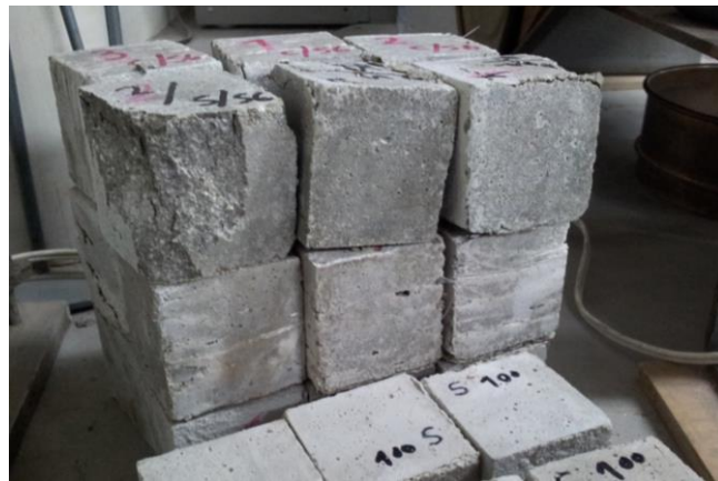
Figura 3.25 – Muestras ensayadas para la resistencia a la compresión
