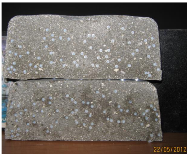
Muestra 1 Fibra óptica con recubrimiento plástico
