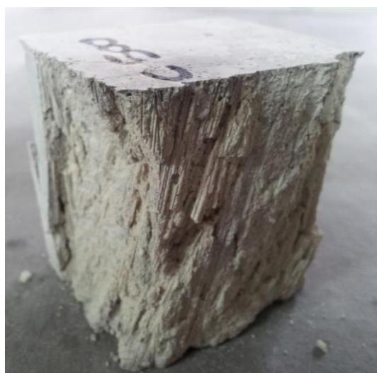
Figura 3.45 – Muestra a temp. 500 °C CON fibra óptica después del ensayo a compresión
