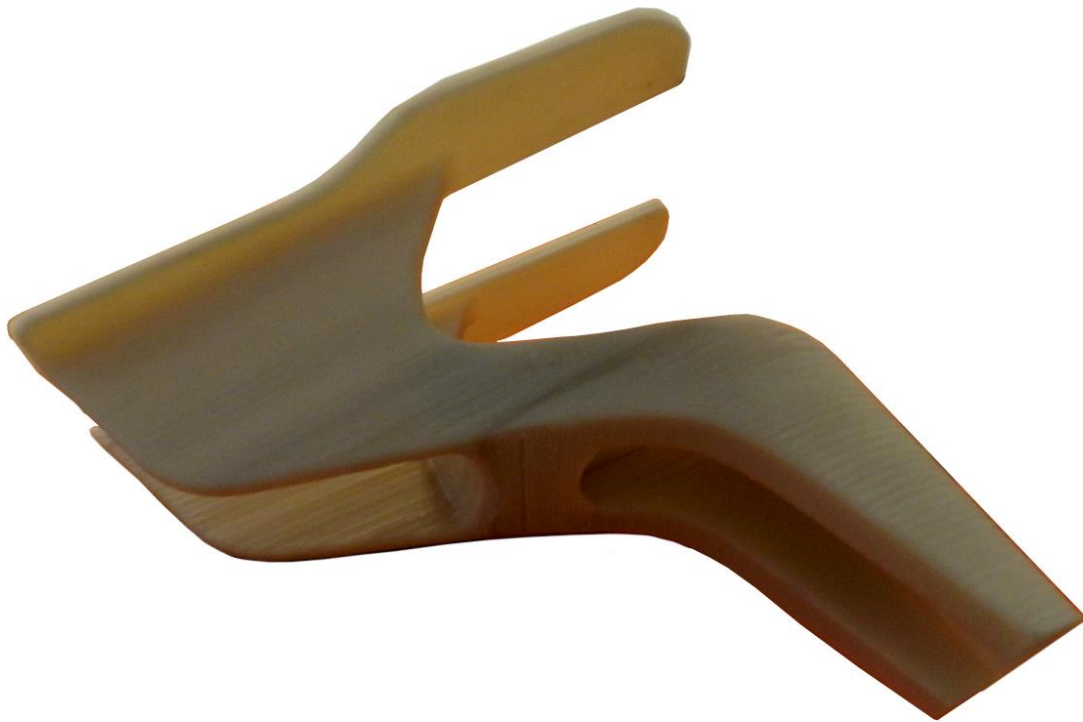
31.- Pieza en ABS impresa mediante FDM en la empresa Cryos 3D; para la línea de mobiliario Volare de esta licenciatura. La pieza se utilizó para prototipos funcionales y posteriormente para el molde de la pieza definitiva en aluminio
