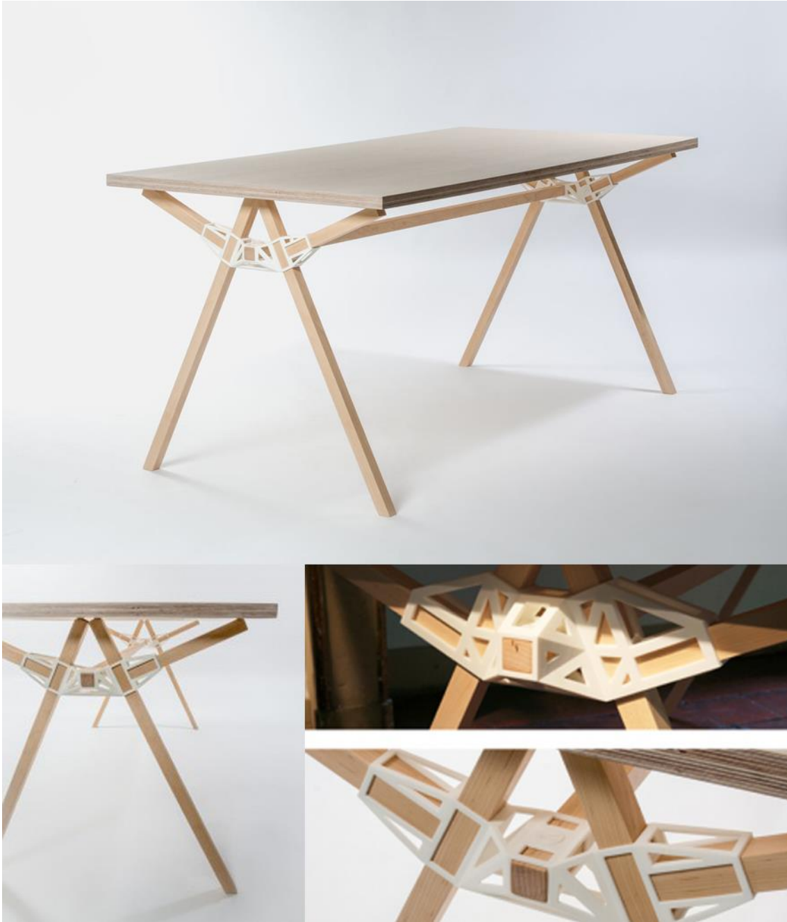
30.- Detalles de la mesa Keystones, abajo a la derecha pieza del prototipo y arriba pieza final cuyas secciones debieron reforzarse. La pieza conectora está impresa mediante SLS
