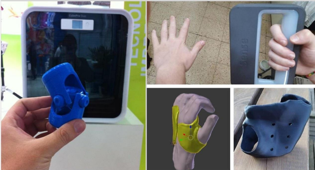
Pieza funcional (articulación) para prototipo; scaneo e impresión de apoyo para protección postural de mano
