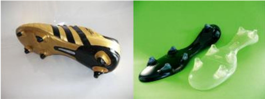
11.- Prototipo de plantillas y zapatilla de futbol Adidas realizada con la tecnología Poly Jet de Stratasys (ver Photopolymer Jetting) con la particularidad que se pueden usar más de un material en la impresión de la pieza.
