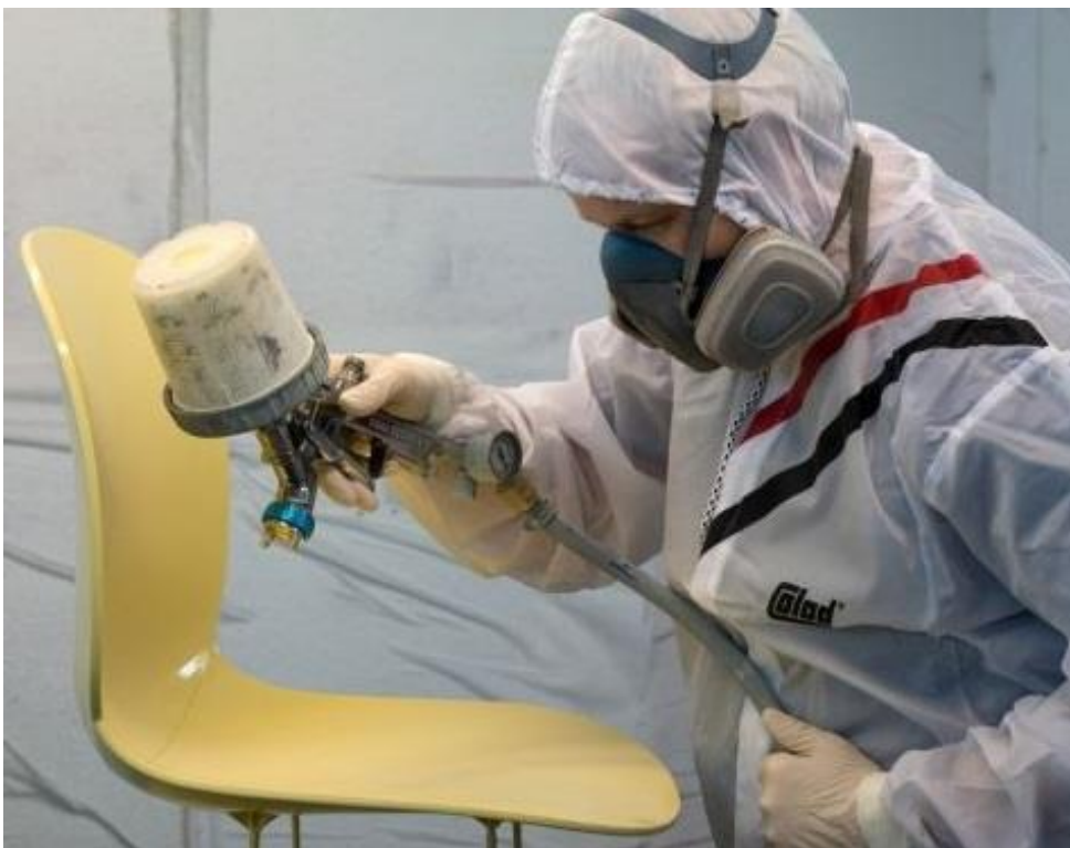
21.- Silla RBM, prototipo del asiento en el proceso de terminación para pruebas funcionales
