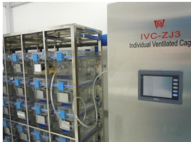
**Figura 13.** Fotografía del Laboratorio de Experimentación Animal (LEA) en el Centro de Investigaciones Nucleares (CIN), Montevideo, Uruguay. En la imagen es posible visualizar el rack ventilado con las cajas herméticas y el equipo de control de temperatura, humedad y presión.
