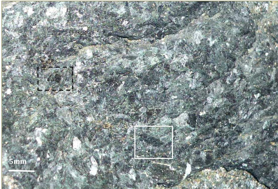
**Figura 3.8-** Muestra de mano de paraanfibolita del sector este del afloramiento de playa Pajas Blancas, en la que se observan buenas secciones basales (recuadro negro segmentado) y longitudinales de anfíbol (recuadro blanco continuo).
