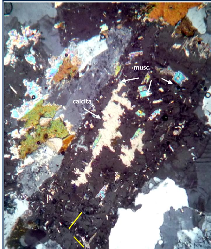
Figura 5.9- En el centro de la figura aparece un cristal de plagioclasa fuertemente alterado a calcita y pequeños cristales muscovita secundaria (sericita), la cual crece de forma paralela a las direcciones de clivaje. Largo de la barra de escala 0.5 mm.
