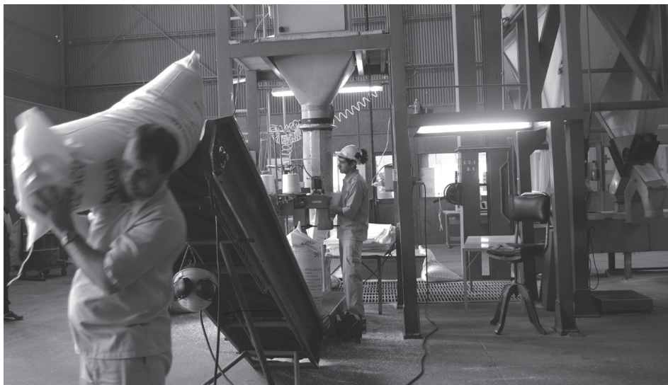
Figura 7. Proceso de embolsado del arroz y de carga en el molino. Autora: Inés Garaza.
