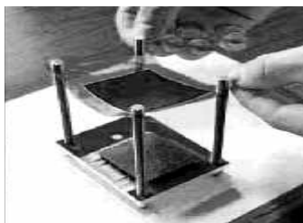
Figura 4 Fotografías del armado de la "Membrane electrode assembly" luego del prensado del catalizador con el carbono sobre el Nafion.
