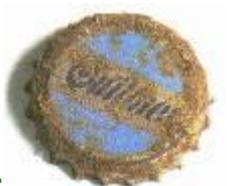
**30 años:** La aleación metálica que forma las tapitas de botellas puede parecer candidata a una degradación rápida porque tiene poco espesor. Pero no es así. Primero se oxidan y poco a poco su parte de acero va perdiendo resistencia hasta dispersarse.
