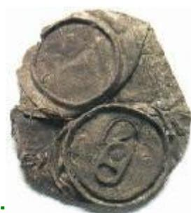
**10 años:** Ese es el tiempo que tarda la naturaleza en transformar una lata de gaseosa o de cerveza al estado de oxido de hierro. Por lo general, las latas tienen 210 micrones de espesor de acero recubierto de barniz de estaño .A la intemperie, hace falta mucha lluvia y humedad para que el oxido la cubra totalmente.
