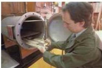
Se introducen paneles al azar para comprobar su resistencia a determinadas fuerzas exigidas.
