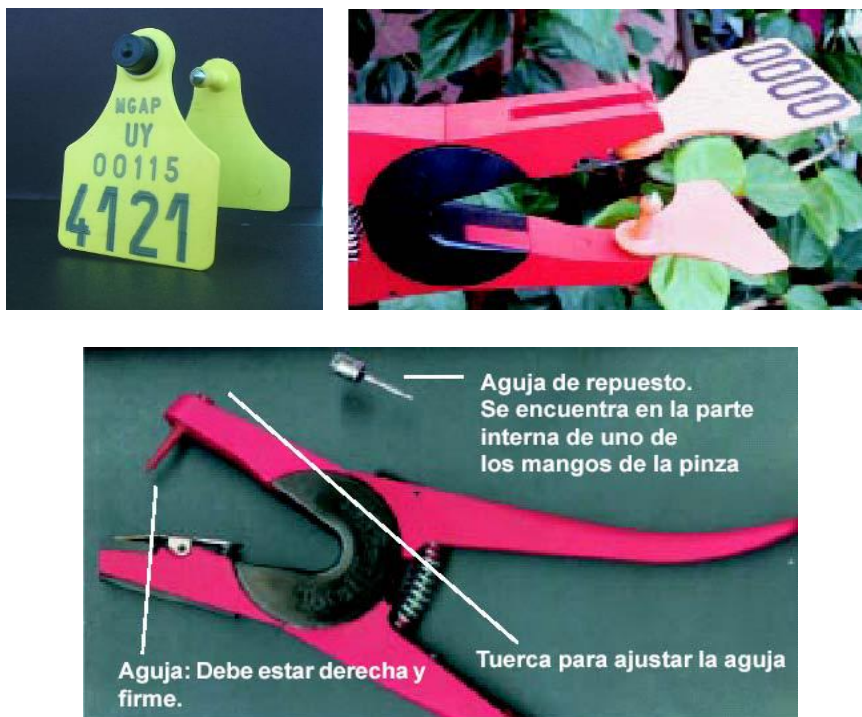
Figura N° 6 Caravana convencional plástica y pinza aplicadora
