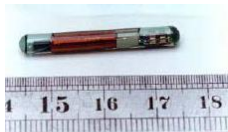
Figura N° 8 - Transponder de 32 mm.
