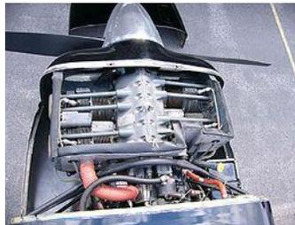
(Motor de Cilindros Horizontalmente Opuestos)
