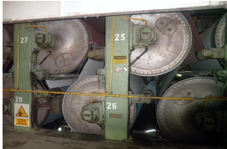
Figura 6: Presión mecánica entre cilindros, Lisadores
