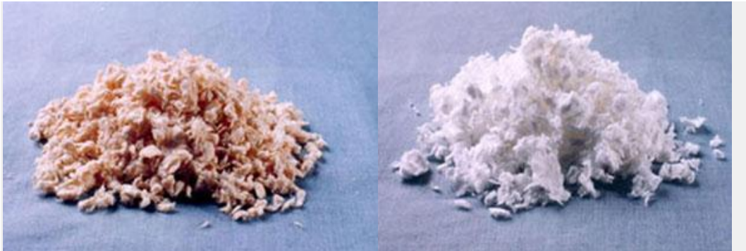
Figura 5: Celulosa cruda o Kraft y celulosa blanqueada o química
