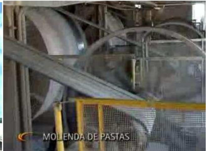
Se puede identificar dos tipos de molienda: molturación por vía seca o por vía húmeda.
