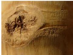
**Bolsas de resina:** La resina es una sustancia que se produce naturalmente en la madera para responder a daños en la corteza como pueden ser los nudos muertos. Representan una discontinuidad que debilita la resistencia de la pieza de madera. El exceso de resina dificulta la pintura o el barniz de la madera y además, con el calor la resina tiende a fluir y puede mancharla. Esto último se puede evitar secando la madera en estufa.
