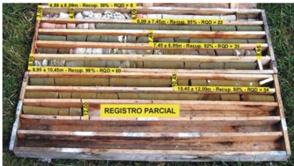
Figura C.2: Perfil litológico del pozo PC06 obtenidos de las campañas realizadas para el Proyecto Itacuruzú
