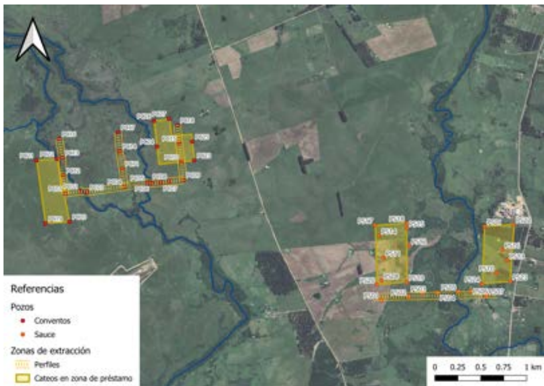
Figura 3.9: Pozos realizados en el marco del proyecto Itacuruzú para las presas sobre el Arroyo Conventos y Arroyo del Sauce
