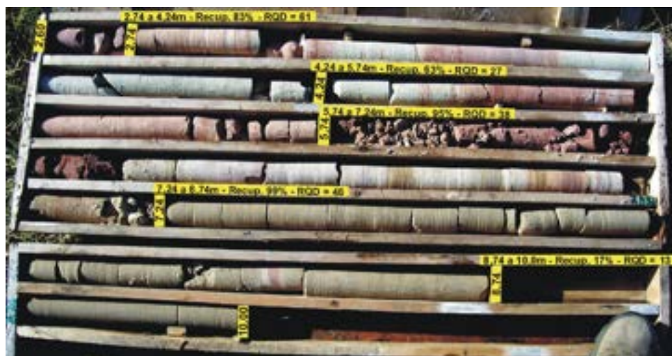
Figura C.3: Perfil litológico del pozo PC09 obtenidos de las campañas realizadas para el Proyecto Itacuruzú
