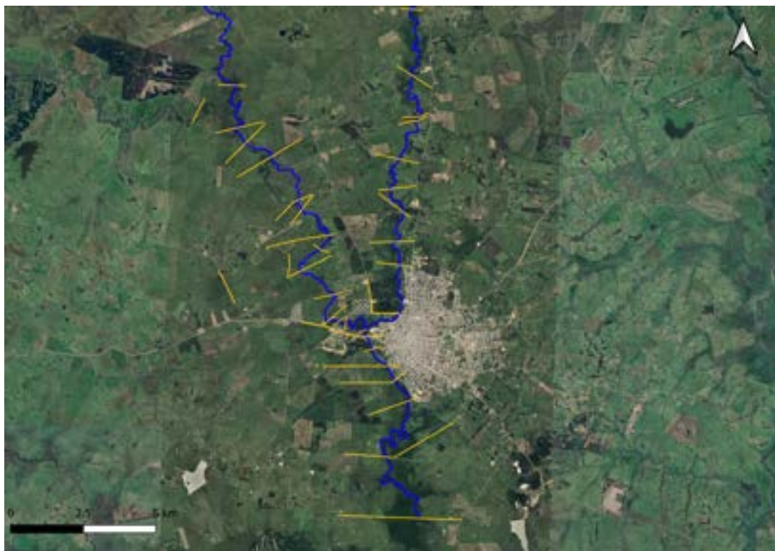
Figura 5.1: Secciones relevadas en el Proyecto Itacuruzú e ingresadas como como secciones transversales
