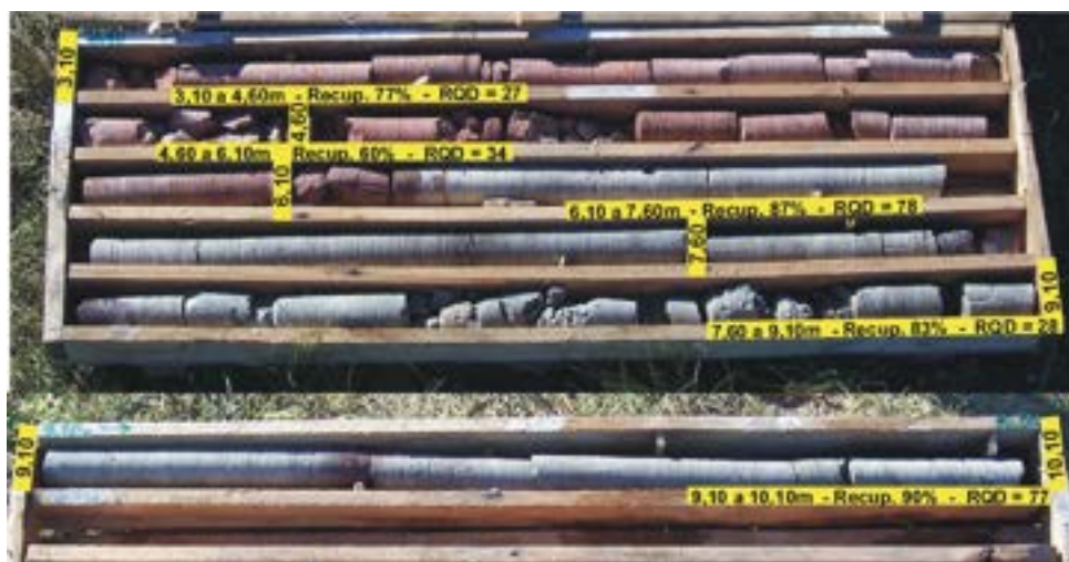
Figura 3.10: Perfil litológico del pozo PC01 obtenidos de las campañas realizadas para el Proyecto Itacuruzú
