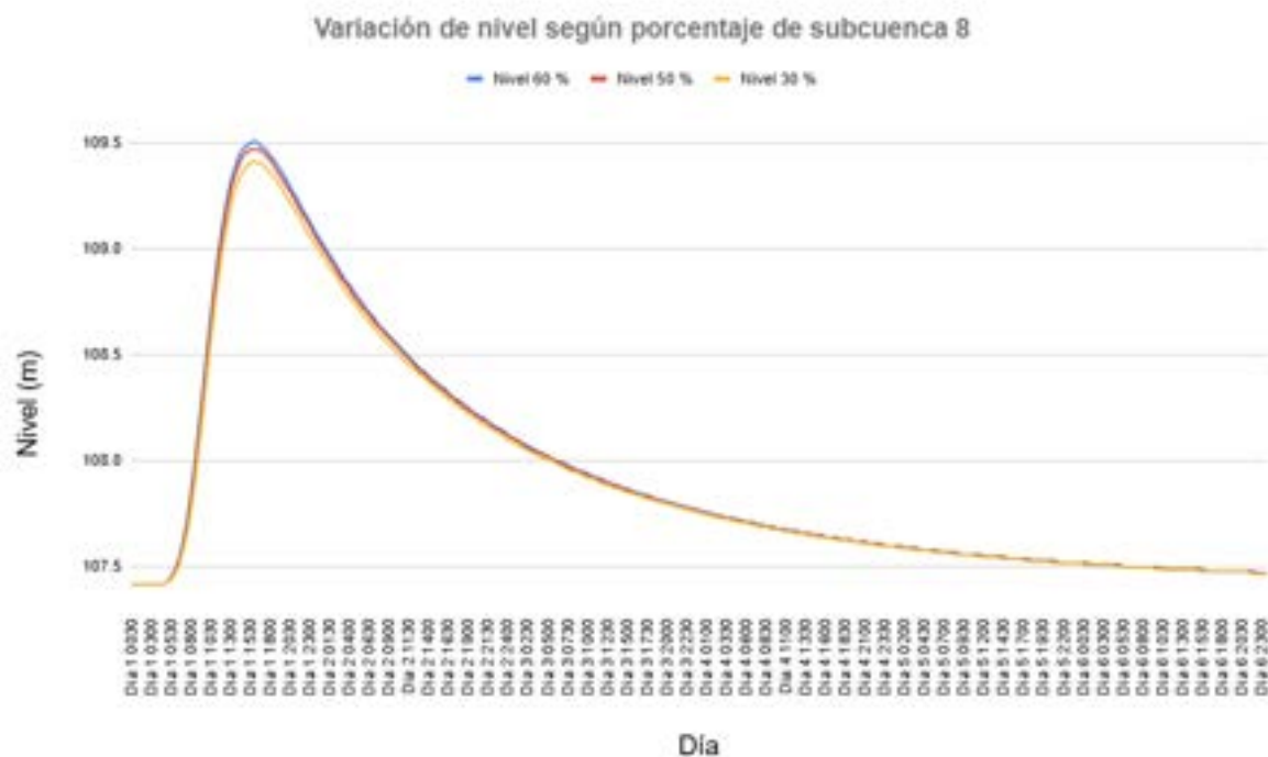
Figura 5.21: Nivel en embalse con diferentes porcentajes de la subcuenca 8 del modelo hidrológico de extremos ingresado
