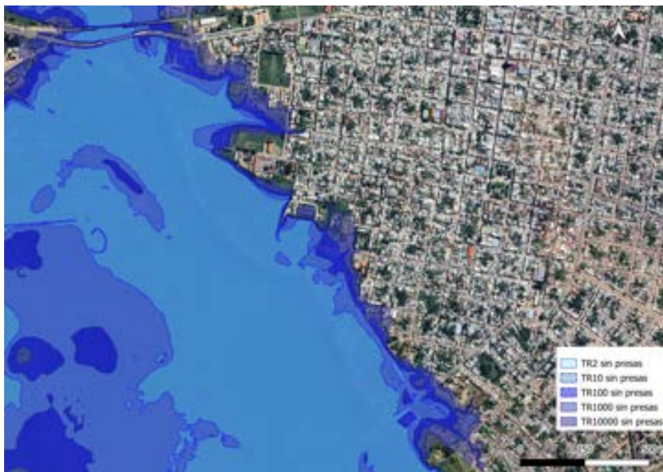
Figura 5.24: Situación sin presas para la zona aguas abajo del puente de la Ruta Nacional N.º 26 bajo efecto de crecidas para distintos tiempos de retorno
